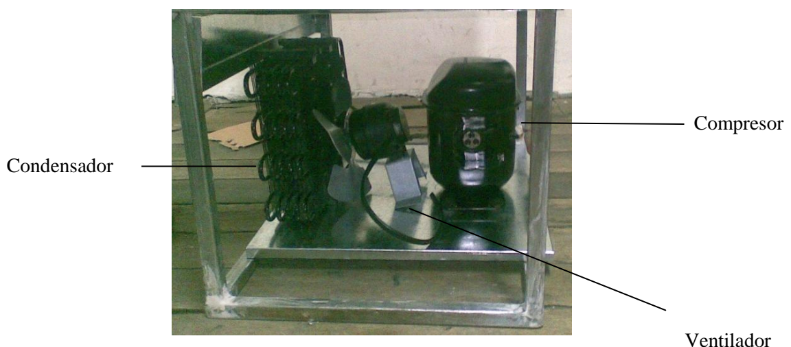
Figura 3.1: Montaje de la unidad
