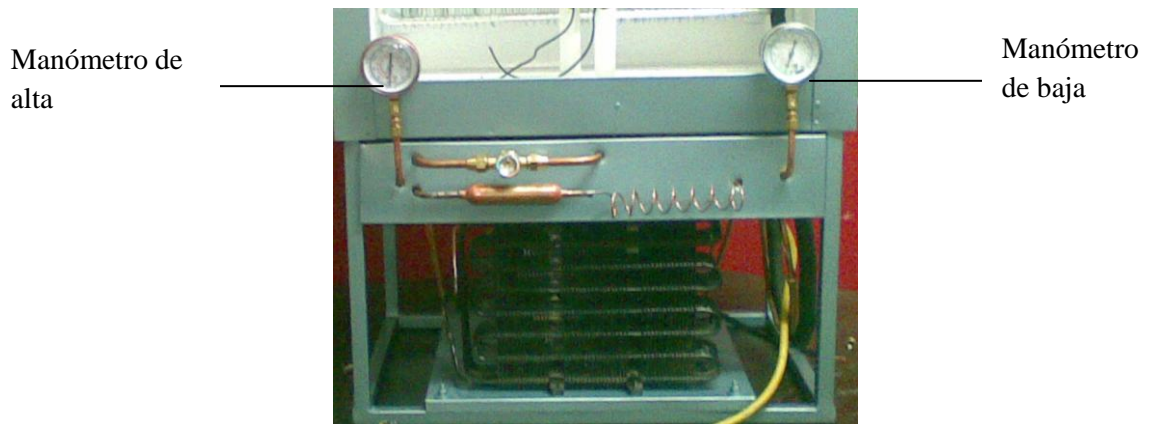
Figura 3.4: Montaje de los manómetros
