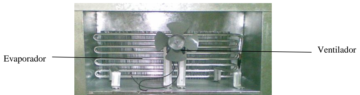
Figura 3.3: Montaje del evaporador y ventilador
