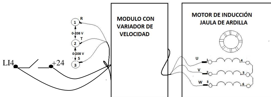
Figura 3.34: Diagrama de conexión del motor de inducción jaula de ardilla.
