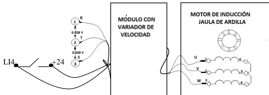
Figura 3.33: Diagrama de conexión del motor de inducción jaula de ardilla.
