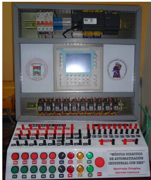
Figura 3.6: Módulo de automatización con HMI
