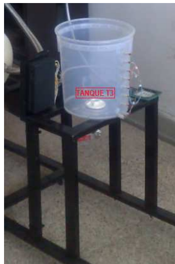
Figura 3.24: Montaje del tanque T3 en la subestructura
