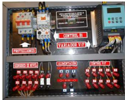
Figura 3.16: Codificación de elementos y dispositivos
