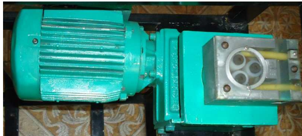
Figura 3.2: Bomba dosificadora peristáltica
