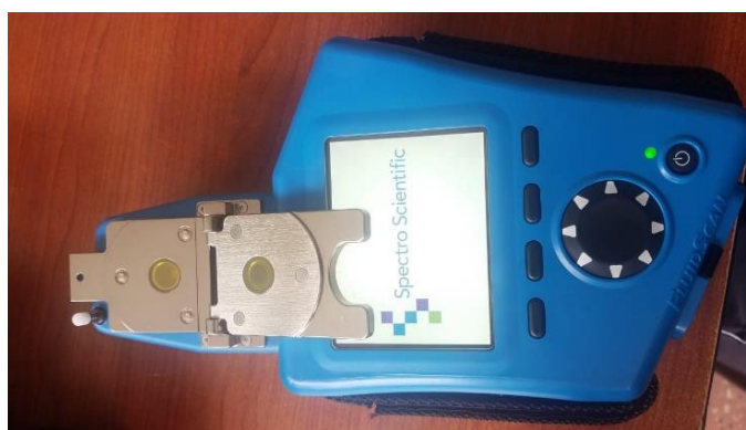
Figura 8-1. Equipo de análisis de aceite FluidScan.
