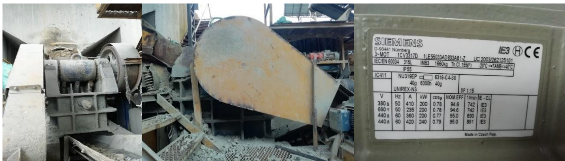
Figura 2-3: Trituradora de mandíbula primeria C1 y su placa
