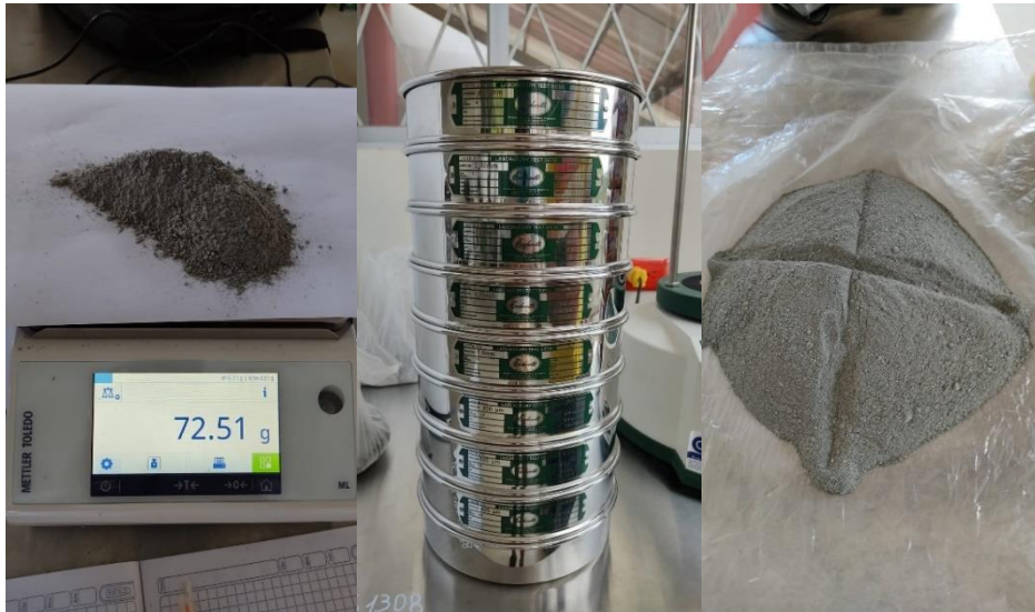
Figura 11-3: Análisis granulométrico en el laboratorio de Minas - ESPOCH
