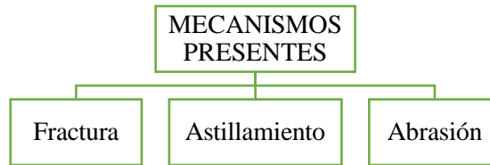
Gráfico 1-2: Mecanismos de chancado o trituración
