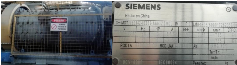
Figura 5-3: Molino de bolas 6'x12' y placa del motor de funcionamiento
