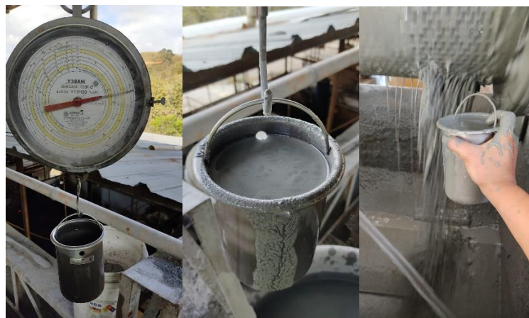
Figura 9-3: Toma de datos de densidades
