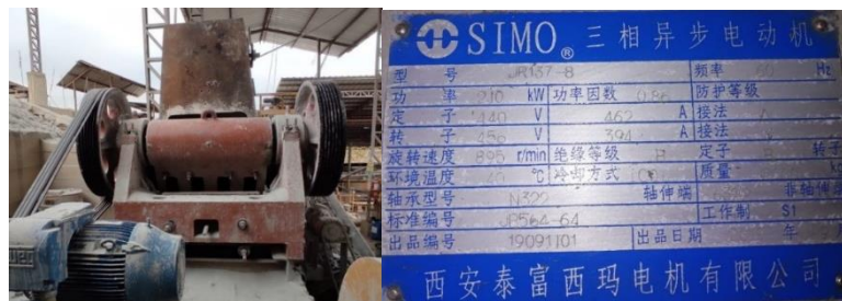
Figura 4-3: Trituradora de mandíbulas primaria 2 C1 y su placa
