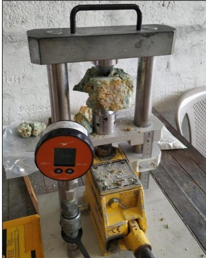
**Figura 3-3:** Ensayo de carga puntual.
