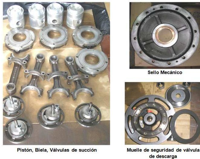
Figura 81. Elementos Expuestos a Desgaste
