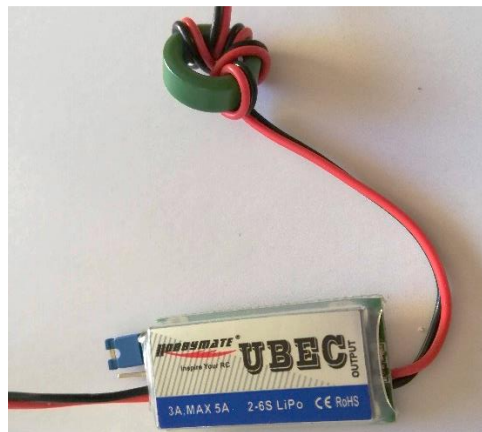
Figura 2-2. Regulador de voltaje 5v/3A de UBEC
