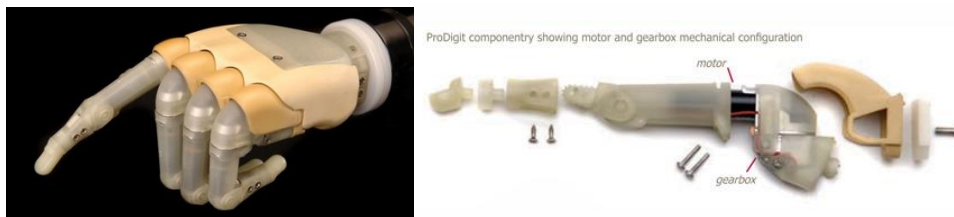
Figura 10-1. Mecanismo con motor en cada junta de la mano i-LIMB
