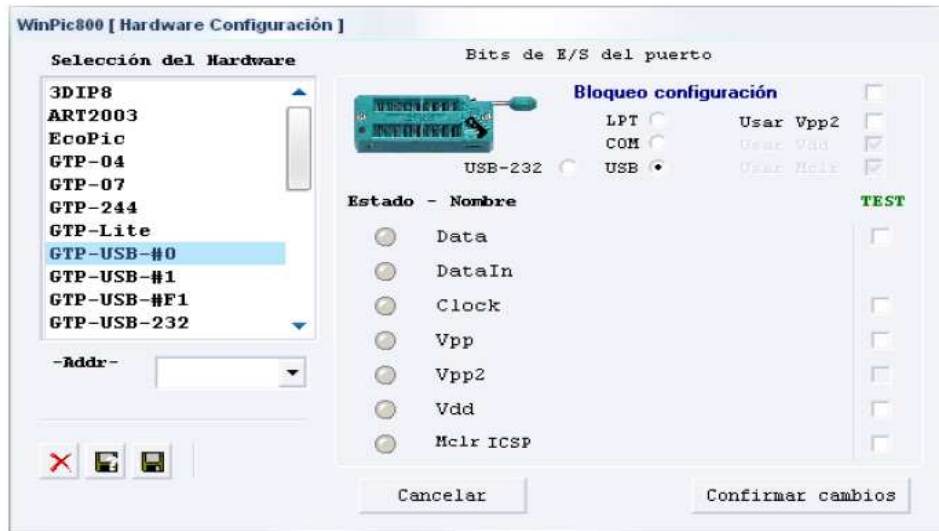
FIGURA II.19. Desactivando Bloqueo de Configuración
