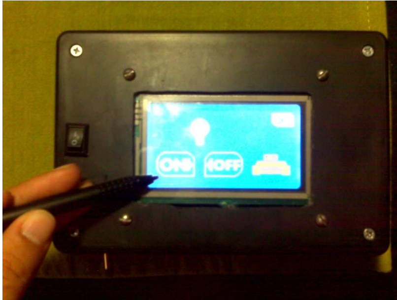
FIGURA V.68. Transmisor – Encendido y Apagado
