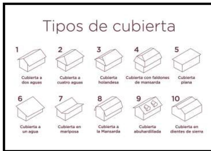
**Figura 12-2:** Tipos de cubierta para instalaciones industriales
