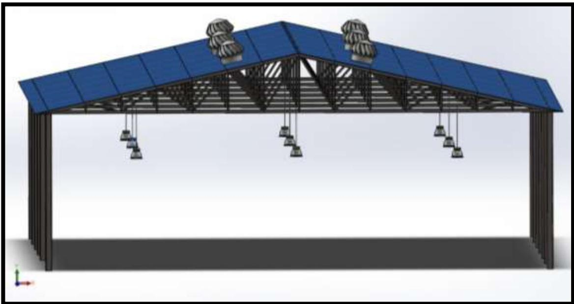
**Figura 16-3:** Diseño 3D con ubicación de luminarias
