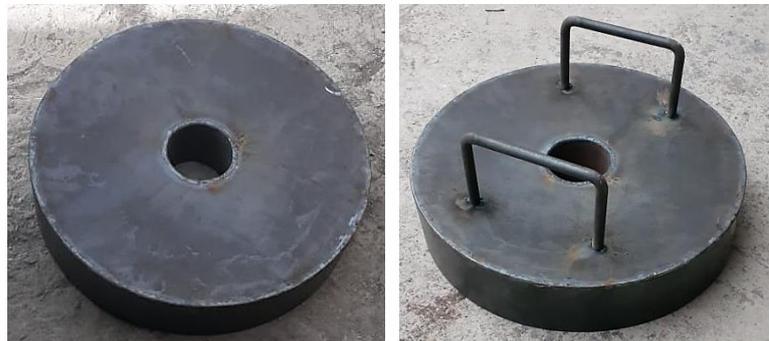
**Figura 13-4:** Carcasa de la tapa del horno
