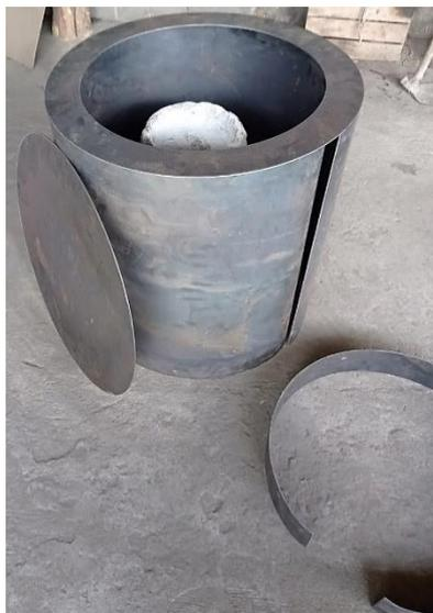
**Figura 4-4:** Carcasa del cuerpo del horno y tapa
