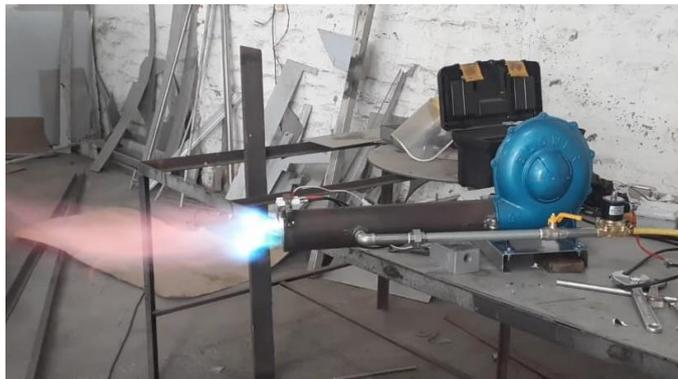
**Figura 17-4:** Prueba del quemador de aire forzado
