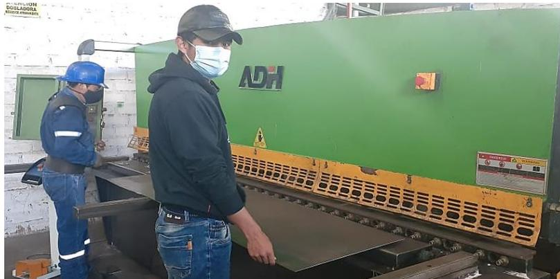
**Figura 1-4:** Corte de la carcasa del cuerpo del horno y carcasa de la tapa
