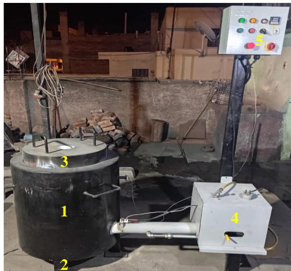
**Figura 21-4:** Componentes del horno de fundición
