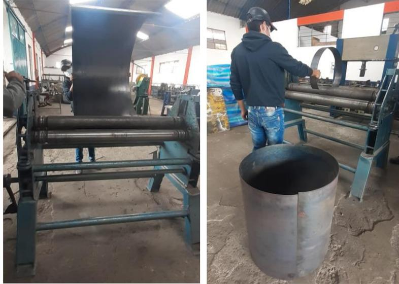
**Figura 3-4:** Cilindros para el cuerpo del horno y la tapa
