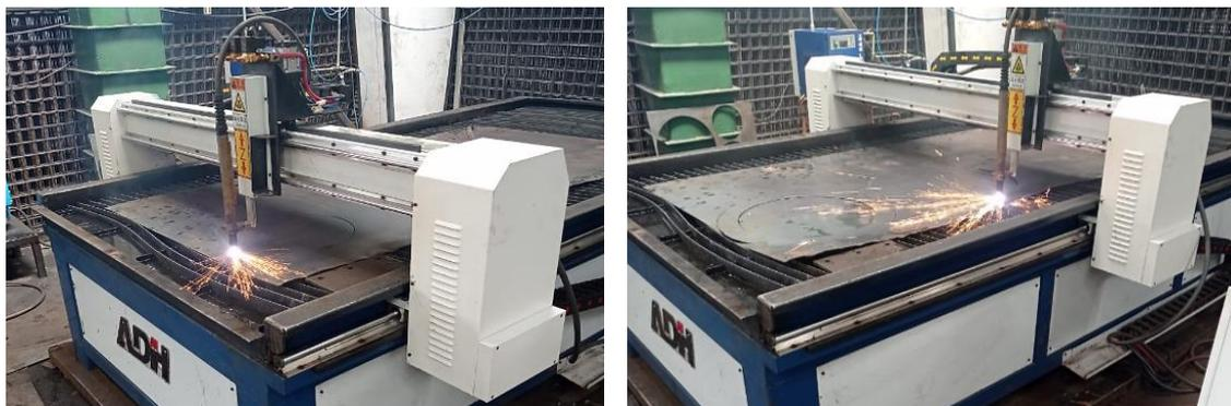
**Figura 2-4:** Corte láser de la base, tapadera y parte superior de la tapa
