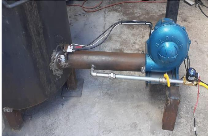
**Figura 18-4:** Instalación del quemador en el horno
