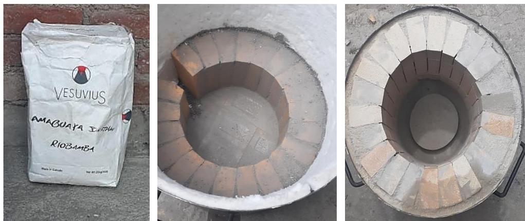
**Figura 11-4:** Unión de los ladrillos refractarios para formar la cámara de combustión
