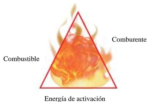
**Figura 8-2:** Triángulo de la combustión
