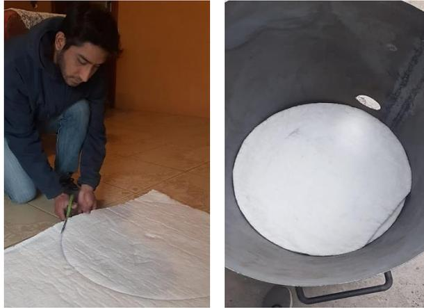
**Figura 7-4:** Corte e instalación de manta fibra cerámica
