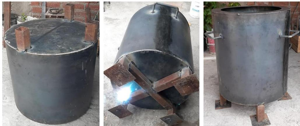
**Figura 6-4:** Soldadura de la estructura de soporte a la carcasa del horno
