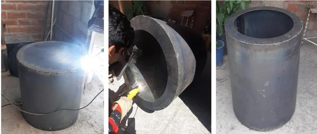
**Figura 5-4:** Soldadura de la carcasa del cuerpo del horno
