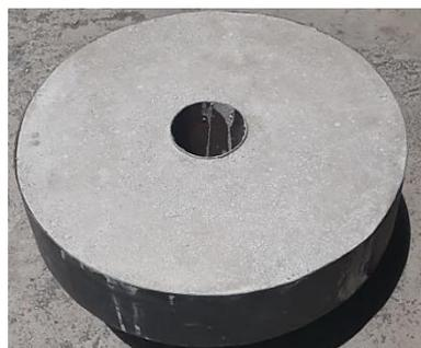
**Figura 16-4:** Secado de la mezcla refractaria
