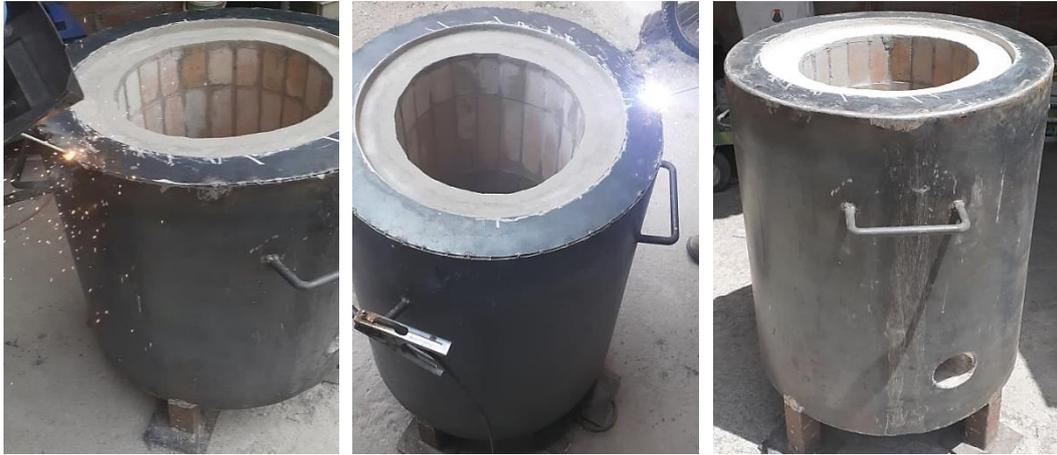
**Figura 12-4:** Soldadura de la tapadera a la carcasa del cuerpo del horno
