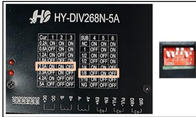
Figura 8-3: Configuración escogida para el driver HY-DIV268N-5A
