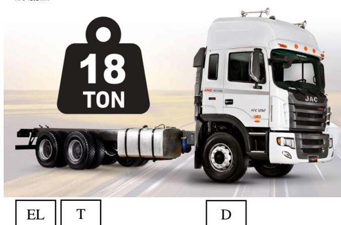
Figura 14-2: Tipos de neumáticos: D (Direccional), T (Tracción) y EL (Ejes libres)
