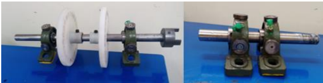
Figura 24-3: Montaje de elementos de transmisión
