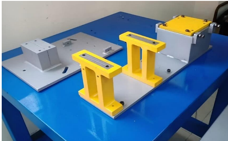
Figura 23-3: Posicionamiento de placas base a mesa de trabajo
