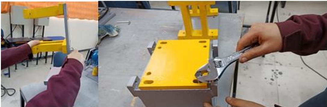
Figura 22-3: Fijación de bases de chumaceras y placa móvil del motor
