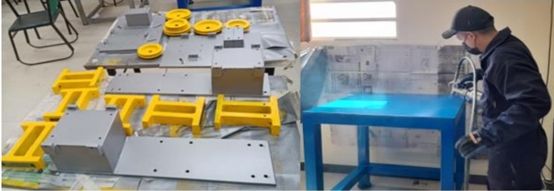
Figura 21-3: Aplicación de pintura a elementos del módulo
