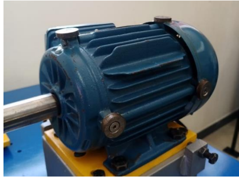
Figura 1-3: Motor trifásico marca WEG W22
