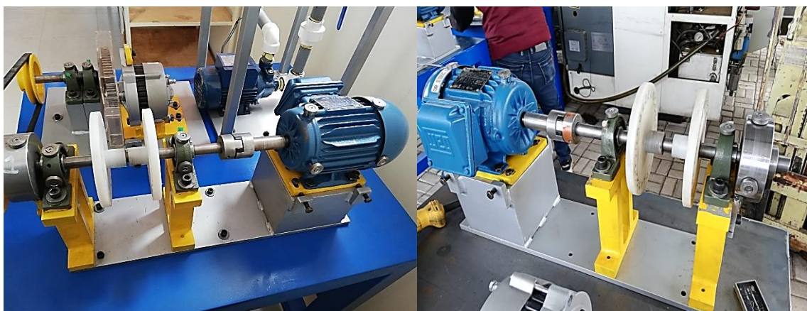
Figura 29-3: Ensamblaje y montaje del módulo vibracional de desbalanceo
