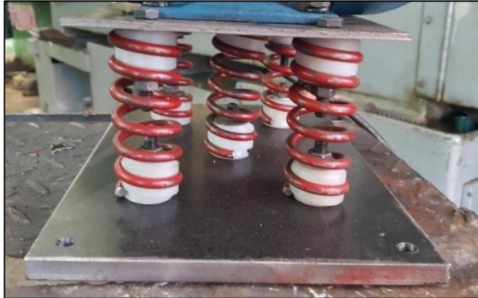
**Figura 19-3:** Unión de los resortes a la base superior
