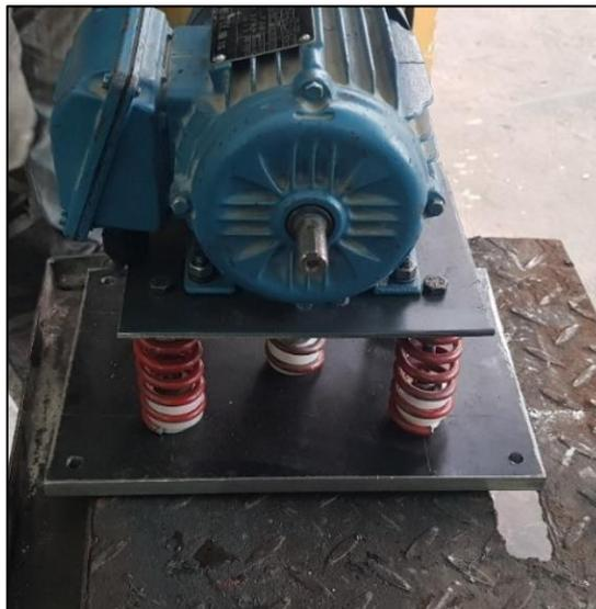
**Figura 20-3:** Motor fijado a la base superior
