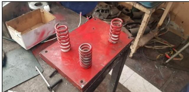
**Figura 17-3:** Unión de los resortes a la base inferior
