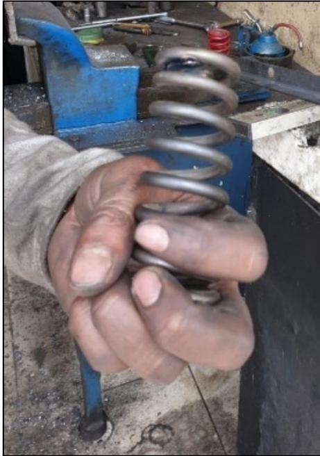
**Figura 13-3:** Muelle mecánico conformado
