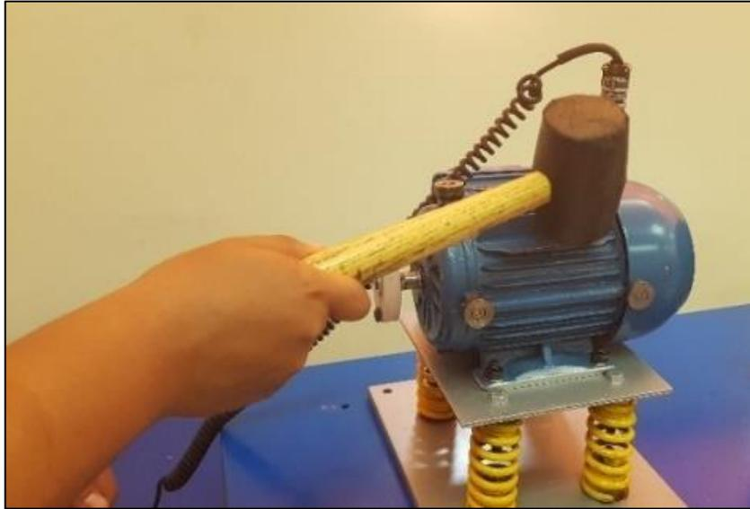
**Figura 2-4:** Prueba de impacto para determinación de frecuencia natural
