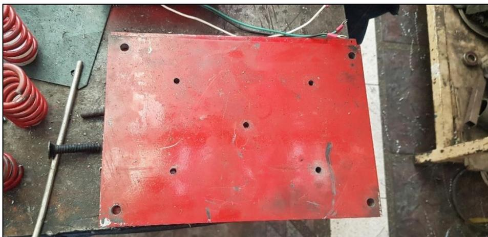
**Figura 10-3:** Disposición de agujeros en la base inferior
