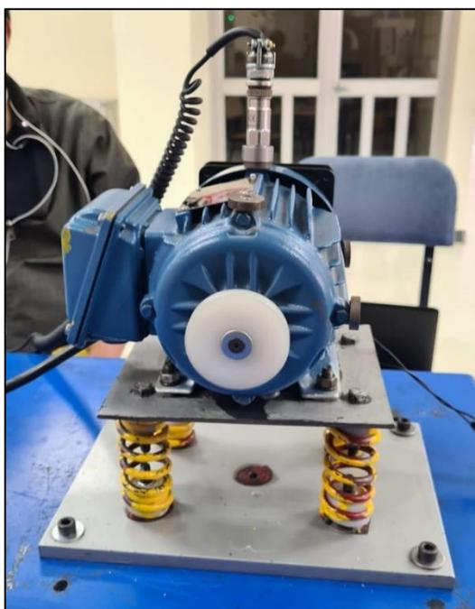
**Figura 6-4:** Medición utilizando Vibracheck
