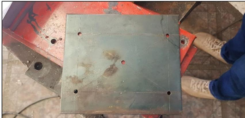
**Figura 7-3:** Disposición de los agujeros en la placa superior
