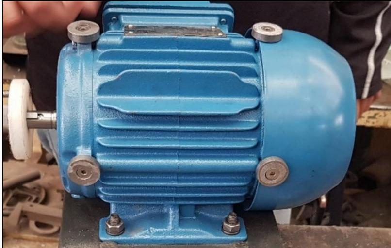
**Figura 21-3:** Motor con los insertos para la medición colocados
