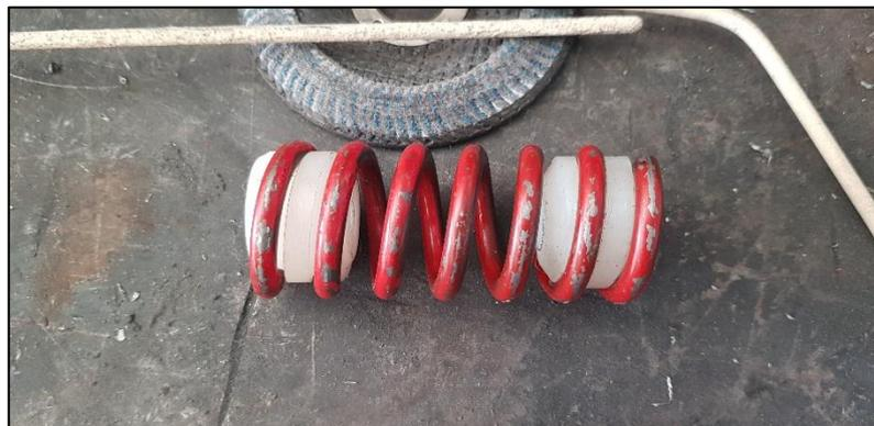
**Figura 16-3:** Resortes con las piezas auxiliares de nylon para la unión
