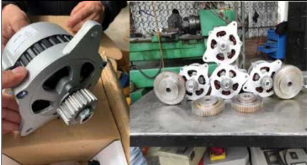
Figura 35-3: Montaje del piñón sobre el eje del alternador
