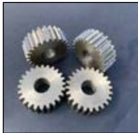
Figura 33-3: Resultado del mecanizado de piñones
