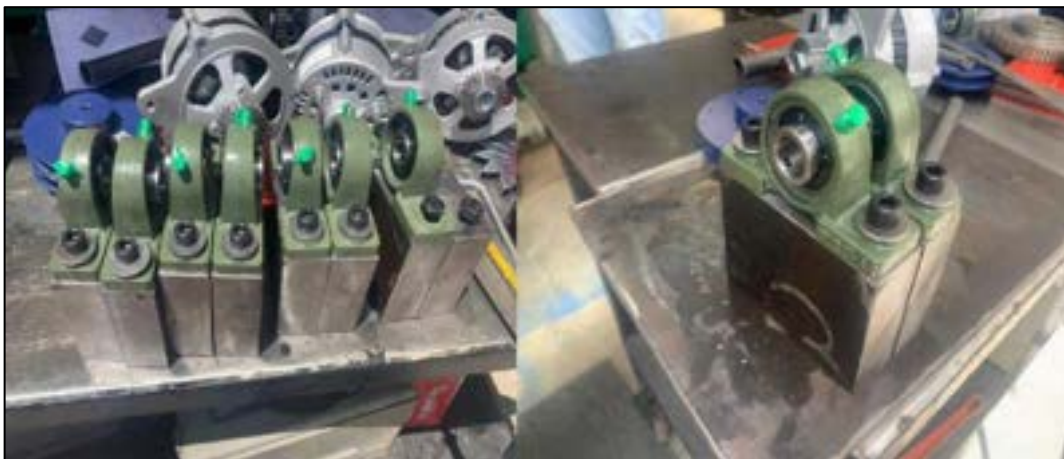
Figura 36-3: Montaje de las chumaceras
