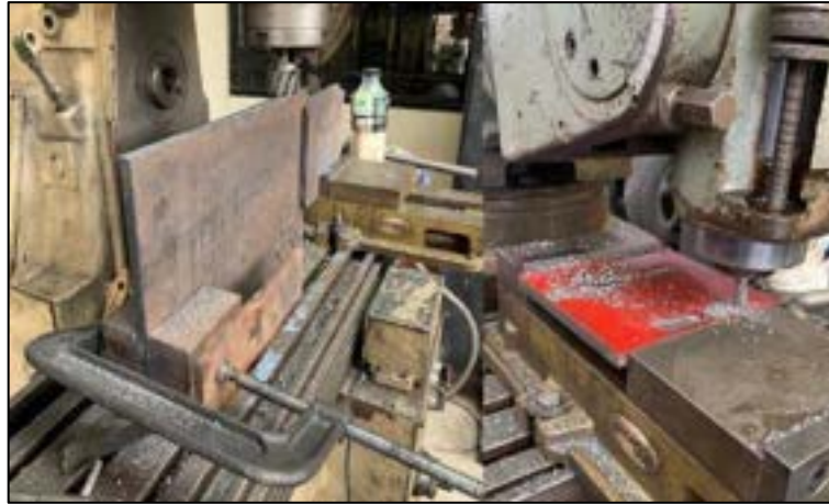
Figura 30-3: Mecanizado de las bases de acero 1020
