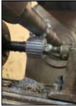
Figura 32-3: Mecanizado del piñón
