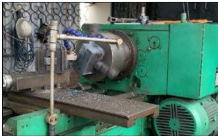
Figura 31-3: Mecanizado de las bases de las chumaceras
