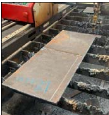
Figura 29-3: Corte de las bases de acero 1020
