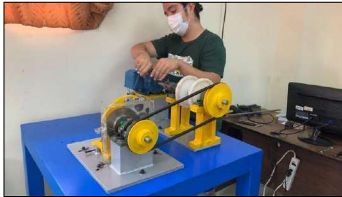
Figura 48-3: Fijación de pernos de anclaje antes de la puesta en marcha
