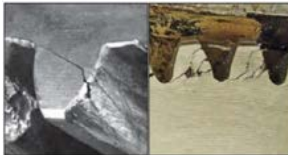
Figura 7-2: Agrietamientos en el flanco del diente
