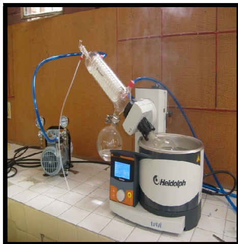
FOTOGRAFÍA No 14. CONCENTRACIÓN DEL EXTRACTO EN ROTAVAPOR.
