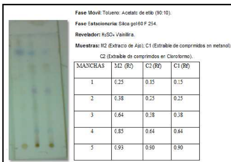
FOTOGRAFÍA No 5. PLACA CROMATOGRÁFICA DEL EXTRACTO DE AJO, CON LOS COMPRIMIDOS EXTRAIDOS CON CLOROFORMO Y METANOL.
