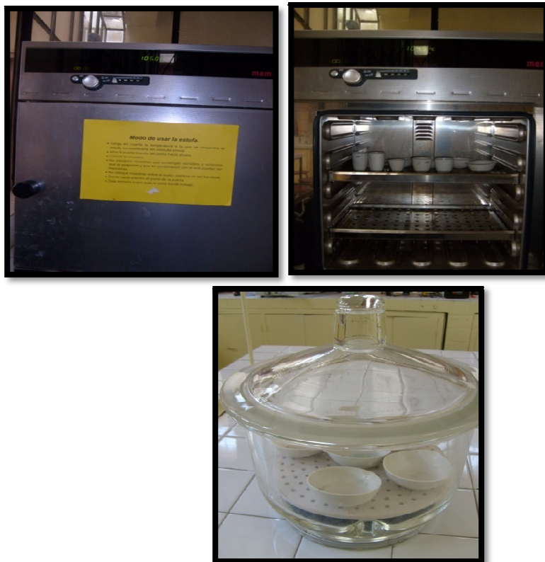
FOTOGRAFÍA No 12. DETERMINACIÓN DE HUMEDAD EN AJO ( Allium sativum. ), JENGIBRE ( Zingiber officinale Roscoe. ) Y MANZANILLA ( Matricaria chamomilla L. ).
