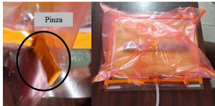
Figura 25-2: Colocación de bolsa de vacío para sellado
