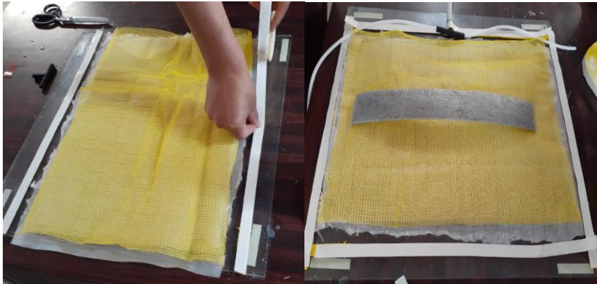
Figura 23-2: Colocación de tacky tape y canales de vacío
