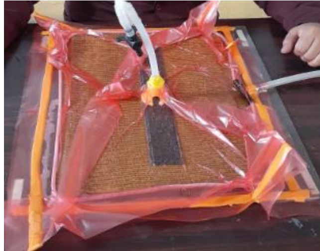
Figura 27-2: Placa infundida y canales bloqueados
