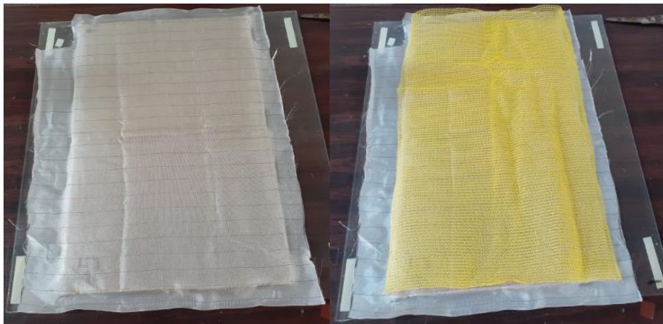
Figura 22-2: Colocación de tejido pelable sobre la fibra de yute
