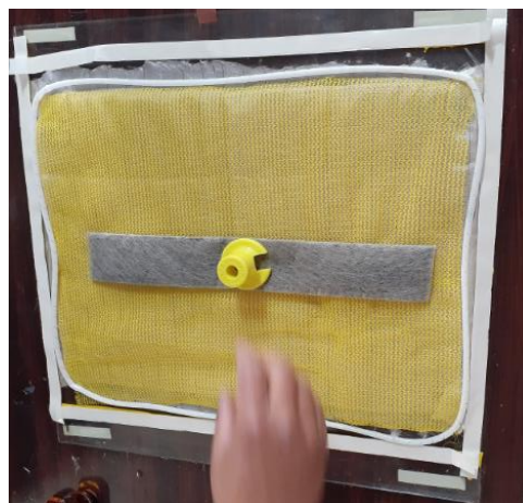
Figura 24-2: Canal de entrada de resina
