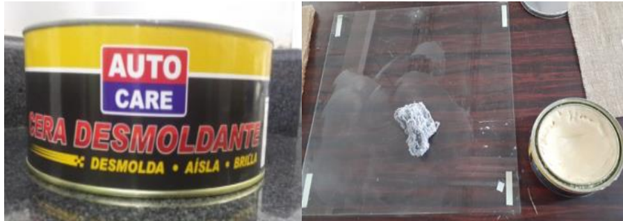
Figura 19-2: Cera desmoldante para preparación superficial
