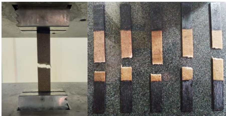
Figura 5-3: Ensayo a tracción de las probetas de fibra de yute
