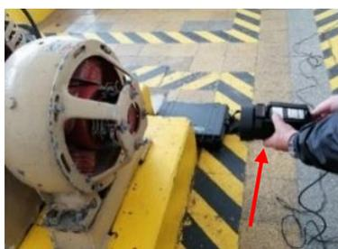
**Figura 5-2:** Lámpara estroboscópica
