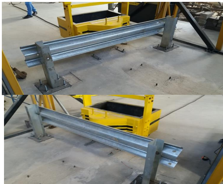
Figura 121-3. Baranda de seguridad completamente instalada para el ensayo
