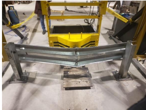
Figura 129-4. Probeta completamente deformada
