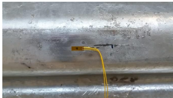
Figura 118-3. Galga extensiométrica soldada en la baranda.
