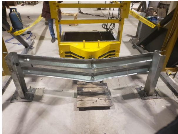
Figura 135-4. Probeta completamente deformada
