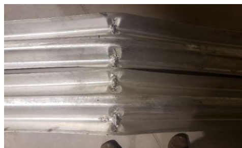
Figura 133-4. Probeta completamente deformada
