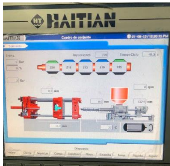
Figura 82-3: Indicaciones del tablero de control
