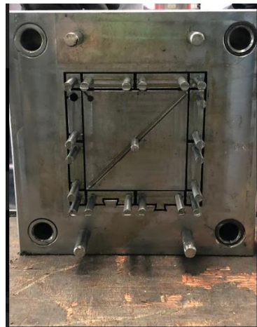
Figura 73-3: Placa cavidad móvil mecanizada.
