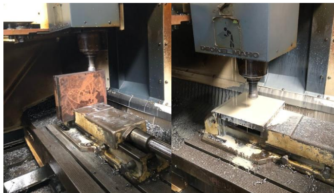
Figura 69-3: Fabricación de las piezas en la fresadora CNC.
