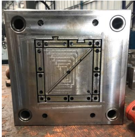
Figura 70-3: Placa de cavidad móvil
