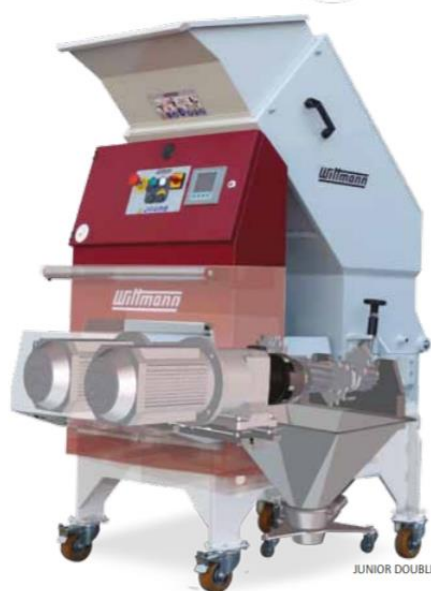
Figura 78-3: Molino de plástico.
