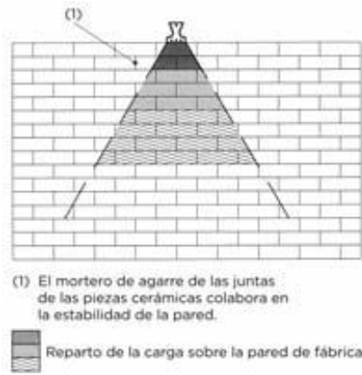
Figura 19-2: Colocación de ladrillos a soga.
