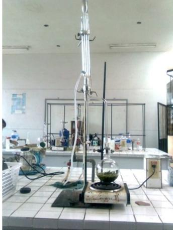
**FOTOGRAFÍA N° 10 EQUIPO DE OBTENCIÓN Y DE ACEITES ESENCIALES**
