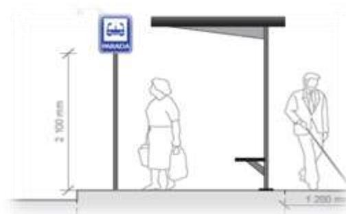
**Figura 29-3:** Señalización y dimensiones de paradas de buses
