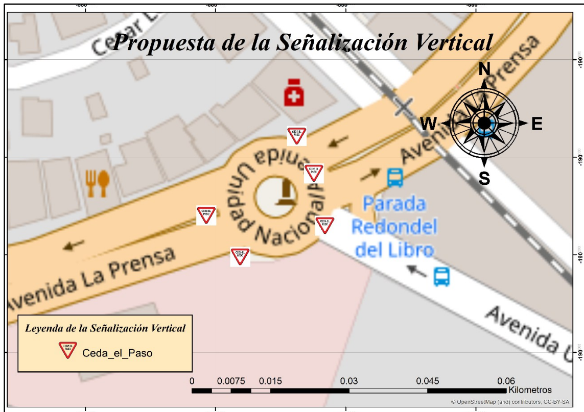
Figura 17-3: Señalización vertical adecuada para la intersección con rotonda. Realizado por: Martínez, P.; Shugulí, T. 2021
