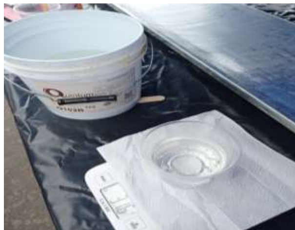
Figura 33-3. Mezcla de resina y catalizador
