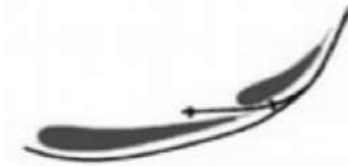
Figura 10-2. Alerón de dos elementos o planos
