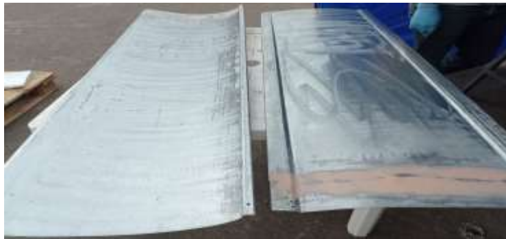
Figura 29-3. Planchas de tol dobladas
