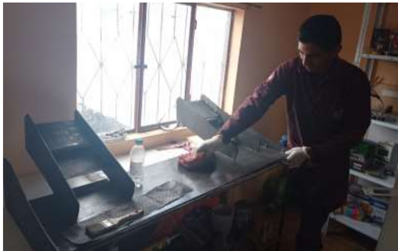
Figura 46-3. Limpieza y retiro de machas del alerón frontal.
