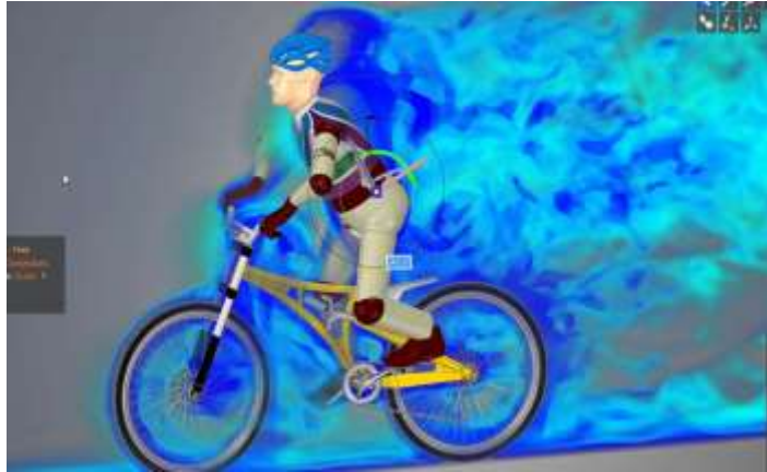
Figura 14-2. Estudio aerodinámico de un ciclista.
