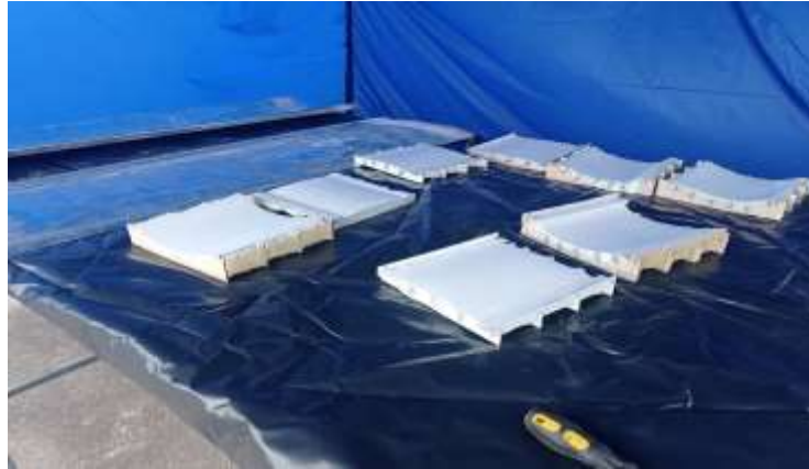
Figura 28-3. Moldes rellenos con masilla
