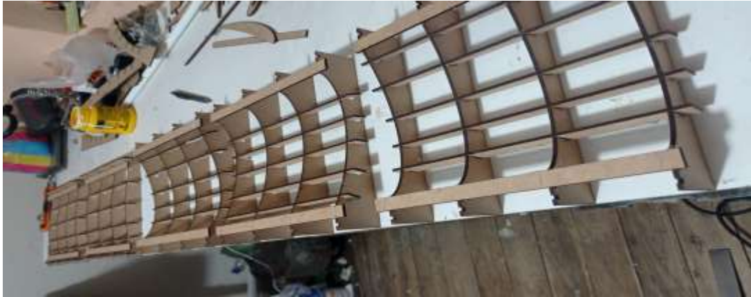
Figura 26-3. Moldes creados mediante el ensamble de las piezas cortadas en la máquina láser Realizado por: (Chuquín Saúl, 2022)
