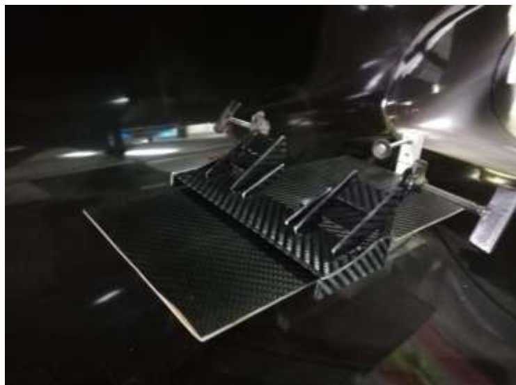
Figura 52-3. Modelo a escala del alerón frontal en el túnel de viento.
