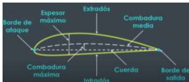
Figura 6-2. Partes de un alerón
