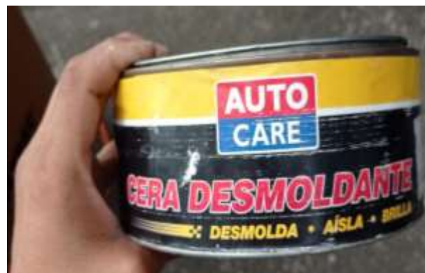
Figura 30-3. Cera desmoldante y aplicación
