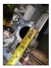
**Figura 52-3.** Dimensionamiento de los conductos de admisión.
