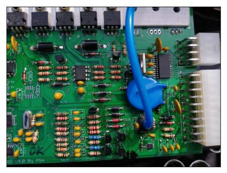
Figura 27-2. Placa electrónica Megasquirt 2pro.
