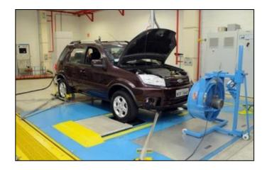
Figura 48-2. Dinamómetro de Chasis.
