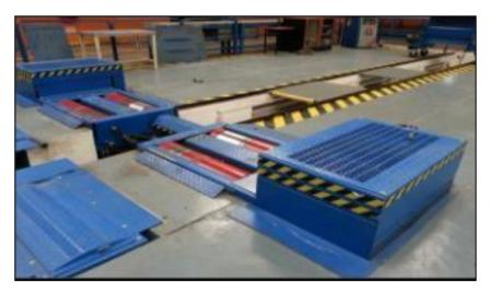
Figura 46-2. Dinamómetro de chasis.
