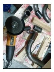
Figura 55-3. Corte de los tubos a medida de los ITBS
