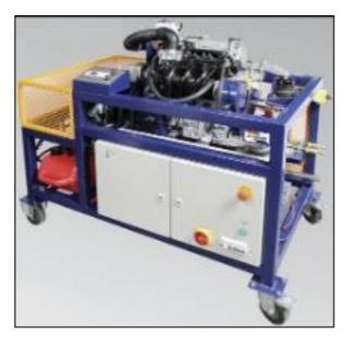
Figura 47-2. Banco dinamométrico acoplado al eje.
