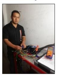
Figura 5-3. Medición de los voltajes de los inyectores.
