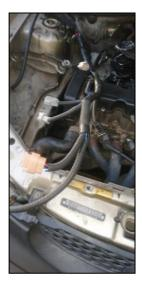
Figura 61-3. Puesta de las abrazaderas en cada salida.
