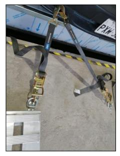
Figura 31-3. Puntos de sujeción dinamómetro
