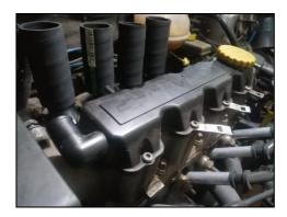
**Figura 60-3.** Instalación de la base a la entrada de los conductos de admisión.
