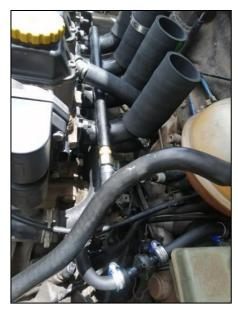
Figura 62-3. Puesta de las abrazaderas en cada salida.
