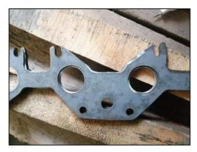
Figura 54-3. Fabricación de la placa metálica base
