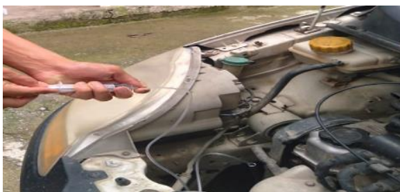
Figura 3-2: Extracción de muestra por el orificio de medida de aceite motor
