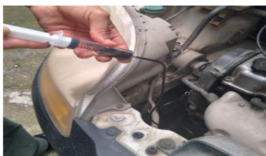
Figura 4-2: Extracción de muestra mediante jeringuilla.
