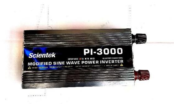
**Figura 4-2:** Inversor de potencia PI-3000
