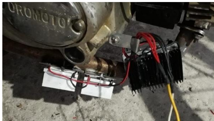
Figura 10-2: Celdas peltier unidas al tubo de escape
