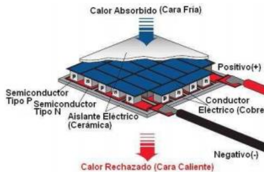
Figura 14-1: Estructura interna de una célula Peltier
