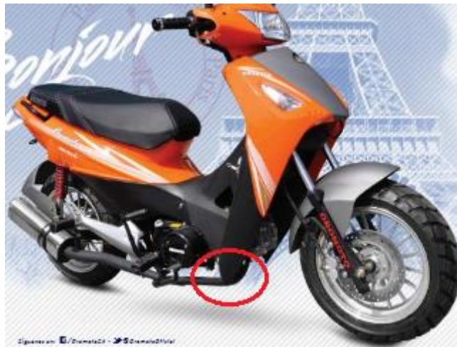
Figura 7-2: Punto adecuado para anclaje de celdas
