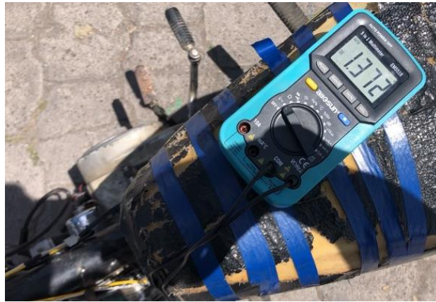
Figura 11-2: Generación de voltaje por parte de las celdas Peltier
