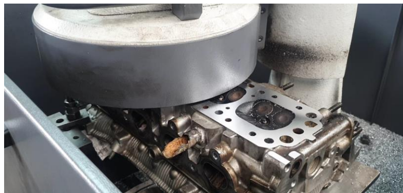
Figura 18-3. Proceso de cepillado de cabezote
