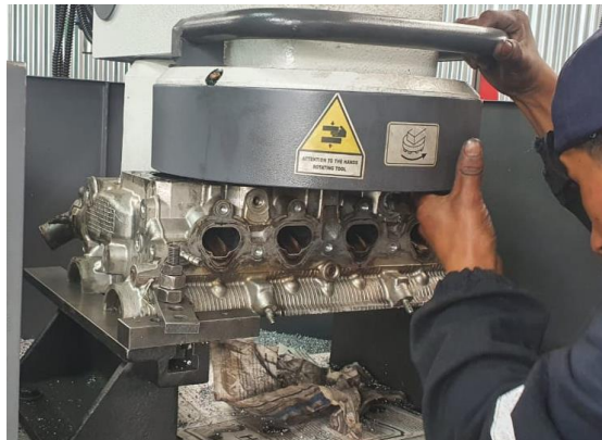
Figura 17-3. Operario de fresadora ajustando la medida de cepillado
