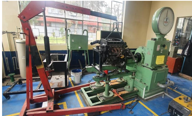
Figura 5-3. Montaje inicial del motor al banco dinamométrico
