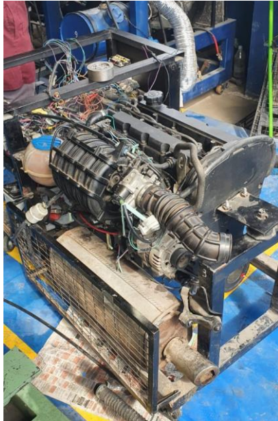
Figura 1-3. Motor en su banco de pruebas original
