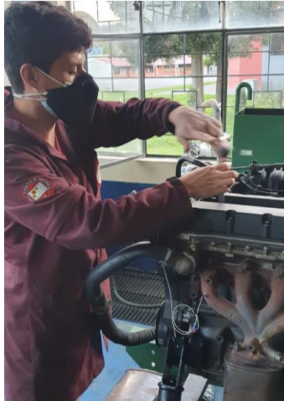
Figura 2-4. Desmontaje de las bujías
