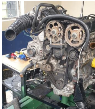
Figura 8-3. Desmontaje de cubierta de la distribución
