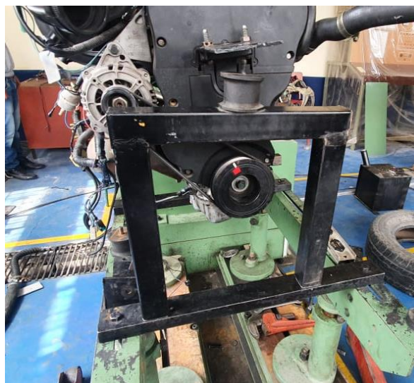
Figura 6-3. Colocación de primer diseño de base
