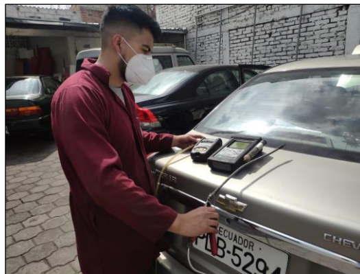
Figura 13-2. Calibración del equipo de medición. Fuente: (Condo C & Manzano M, 2021).
