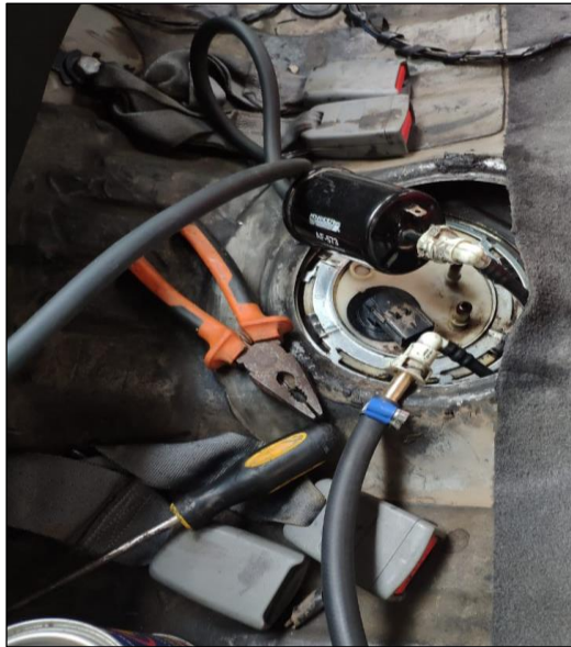
Figura 15-2. Instalaciones del tanque portátil. Fuente: (Condo C & Manzano M, 2021).
