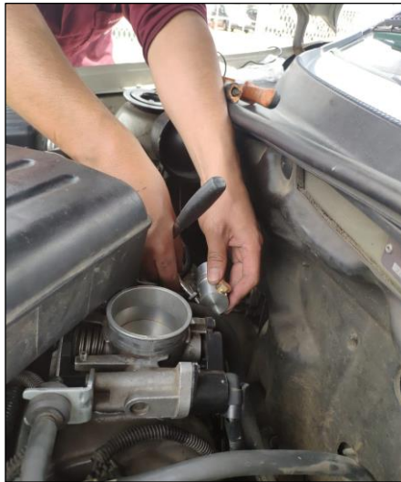
Figura 11-2. Instalación de la válvula. Fuente: (Condo C & Manzano M, 2021).
