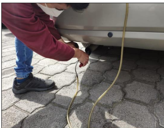
Figura 14-2. Colocación de la sonda en tubo de escape. Fuente: (Condo C & Manzano M, 2021).
