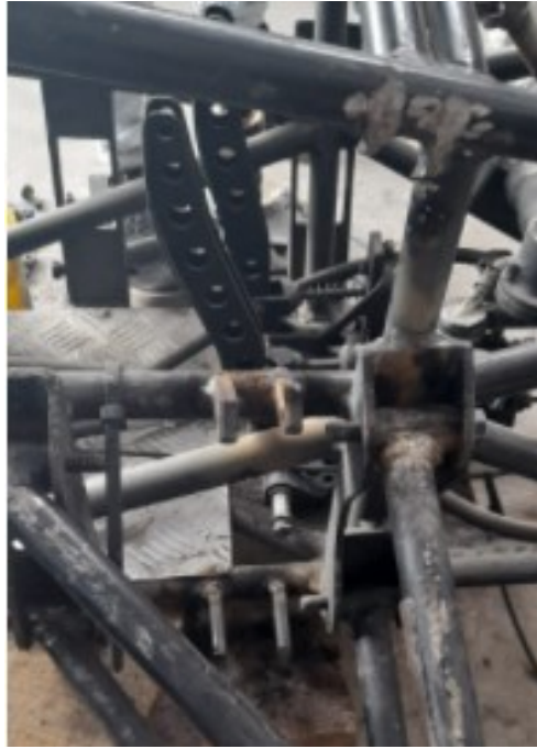
Figura 49-3: Bases soldadas en el prototipo Fuente: Autores
