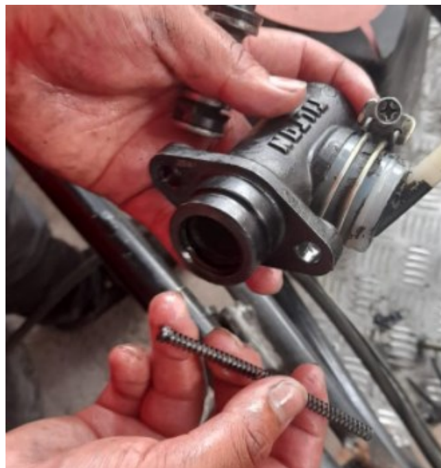
Figura 58-3: Limpieza y reparación del bombín de freno Fuente: Autores
