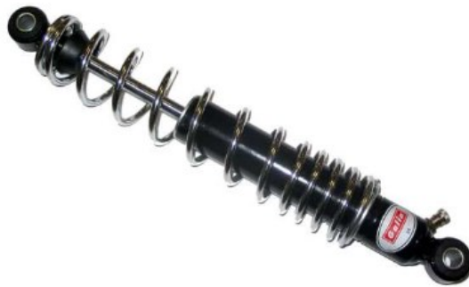
Figura 13-2: Amortiguador hidráulico telescópico moderno. Fuente: (Urbieta, 2003)
