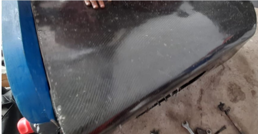
Figura 61-3: Colocación de las fibras delanteras Fuente: Autores
