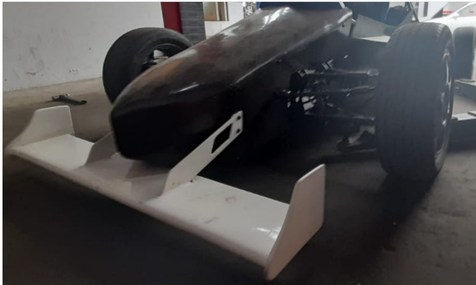
Figura 63-3: Colocación del alerón delantero Fuente: Autores
