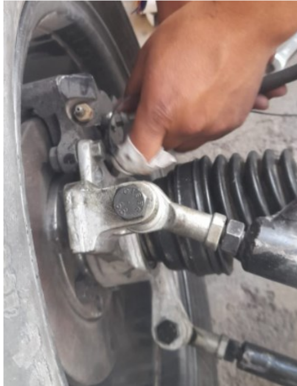
Figura 59-3: Purgado del sistema de frenos Fuente: Autores
