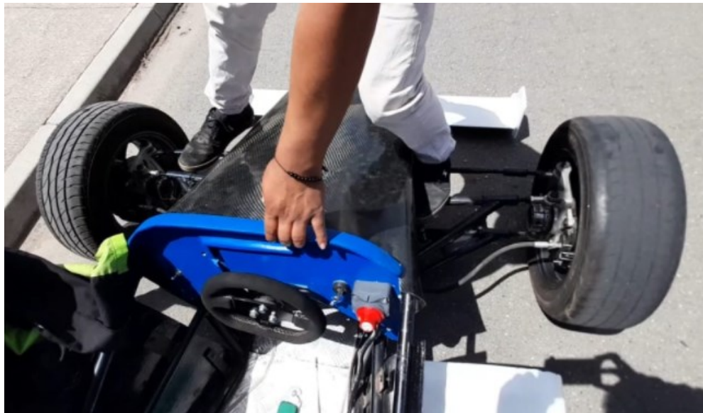
Figura 3-4: Funcionamiento estática de la suspensión delantera
