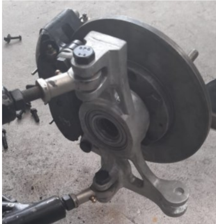
Figura 55-3: Manguetas de aluminio colocadas en el disco Fuente: Autores
