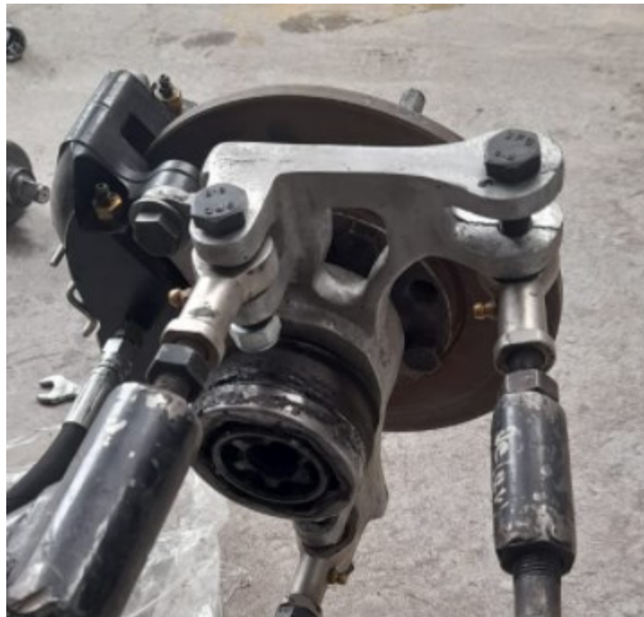
Figura 56-3: Punta de eje colocada en la mangueta Fuente: Autores
