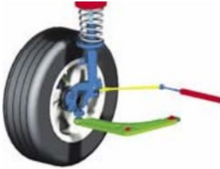
Figura 7-2: Suspensión McPherson Fuente: (Romero, 2006)
