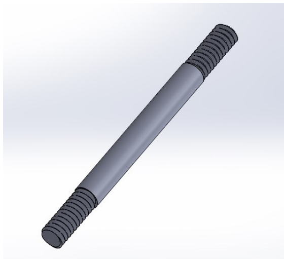
Figura 10-3: Barra Pull trasera Fuente: Autores
