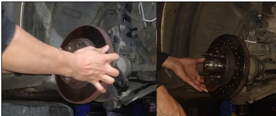
Figura 7-2: Cambio de discos de freno.
