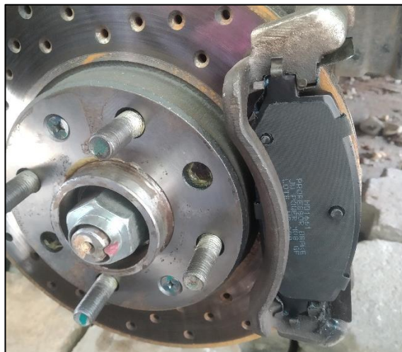
Figura 12-2: Instalación de las pastillas de freno.
