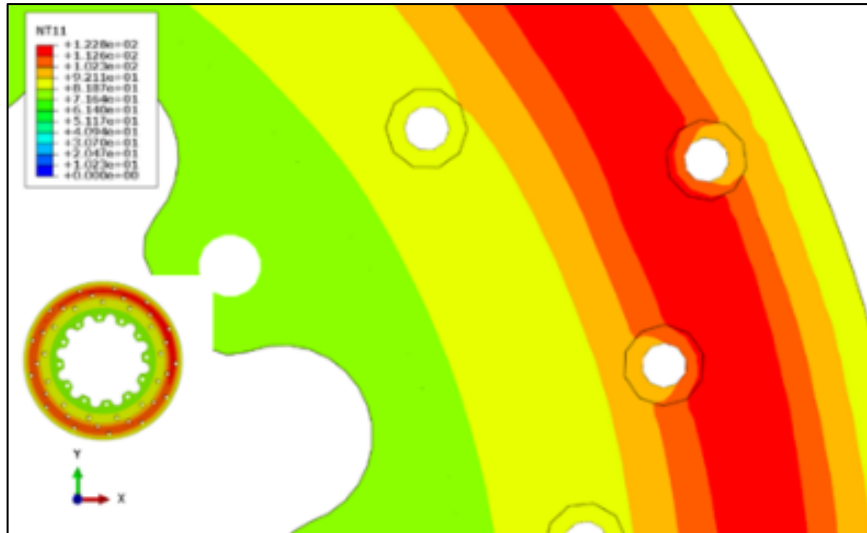
Figura 6-1: Distribución térmica del disco después de la simulación.
