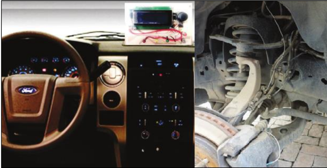
Figura 16-1: Instalación del prototipo en el vehículo.
