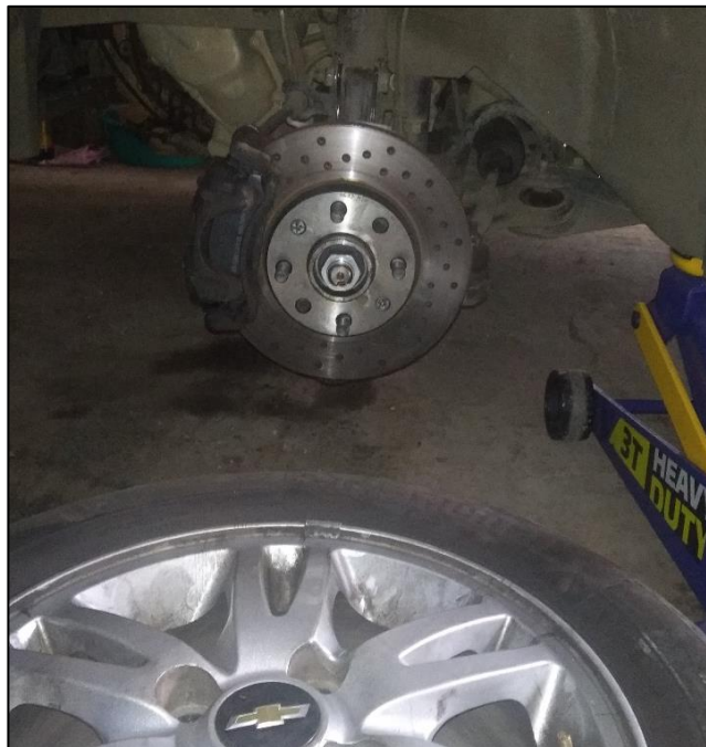
Figura 10-2: Embanque y desmontaje del neumático.
