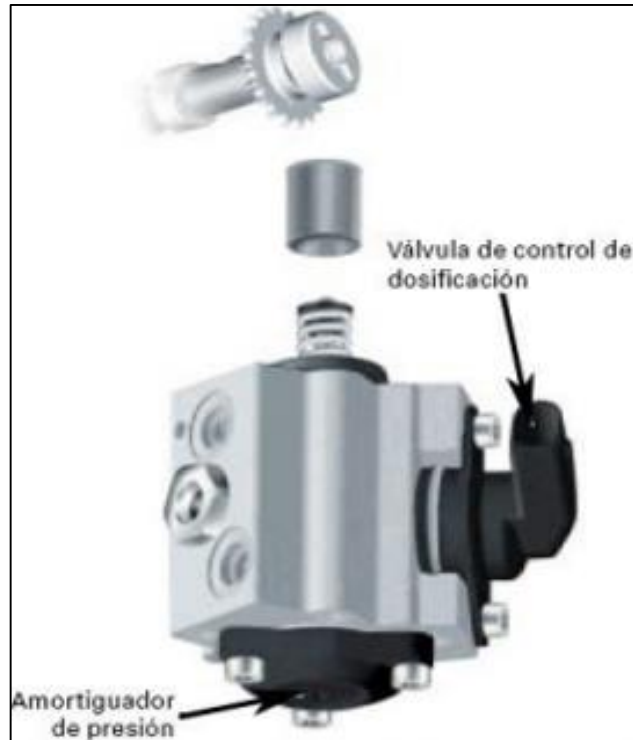
Figura 24-2: Bomba mono- embolo
