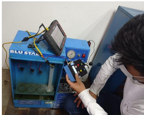
Figura 1-4: Conexión del prototipo con un inyector convencional.
