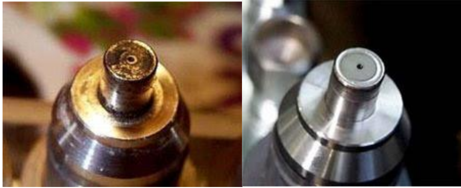
Figura 36-2: Limpieza de inyectores por medio de ultrasonido.
