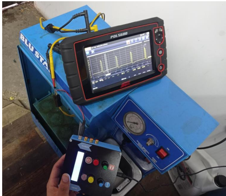
Figura 13-4: Conexión del prototipo con el osciloscopio.
