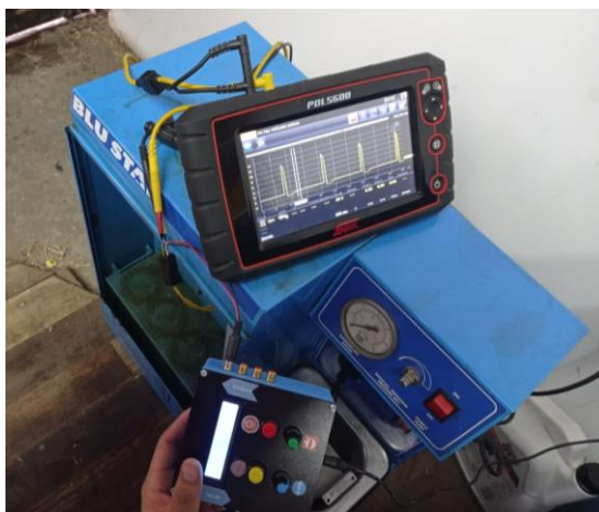
Figura 2-4: Señal del prototipo para activación del inyector.
