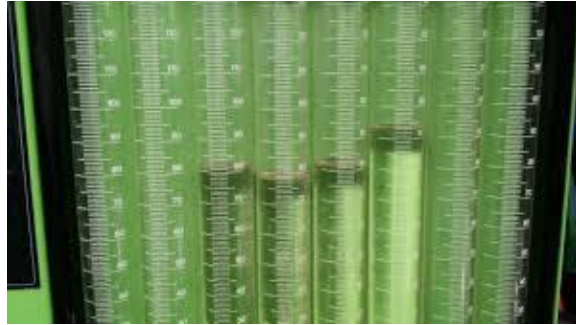
Figura 38-2: Pruebas de caudal inyectores GDI.
