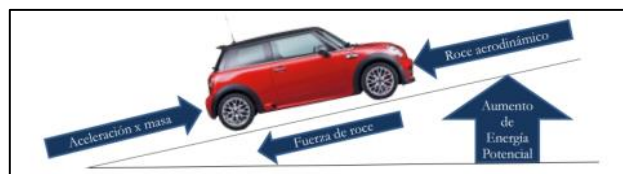
Figura 3-1: Diagrama de fuerzas en el movimiento de un vehículo. Fuente:(Caballero, 2011).
