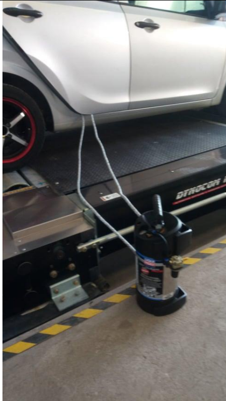
Conexión de Presurizador de Presión.
