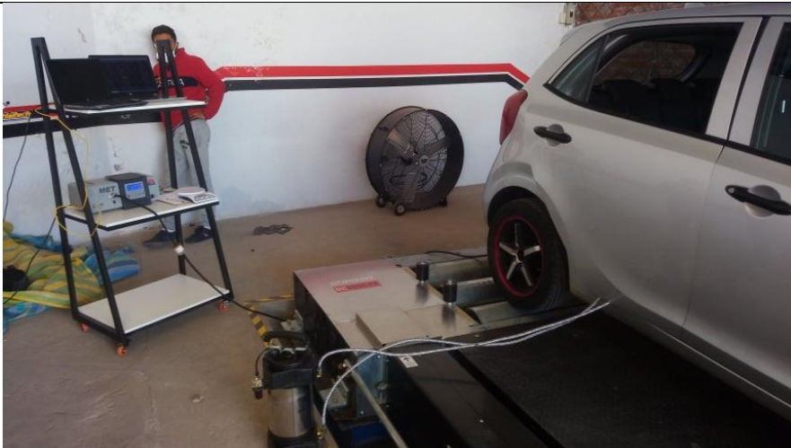
Conexiones Generales: Presurizador, analizador y dinamómetro.
