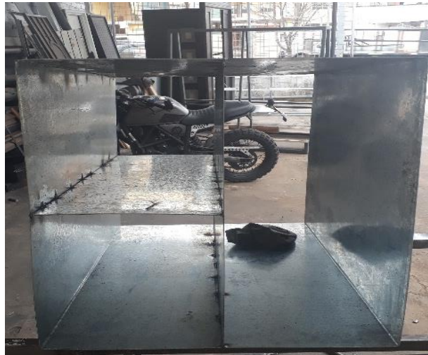
Figura 6-3: Seccionado del contenedor para almacenar tres tipos de aceites lubricantes.
