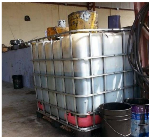
Figura 8-1: Representación de un contenedor de plástico con recubrimiento metálico
