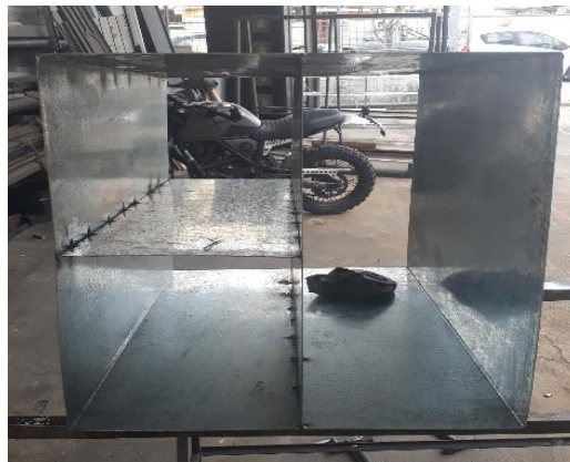
Figura 10-2: Seccionado del contenedor para diferentes tipos de aceite
