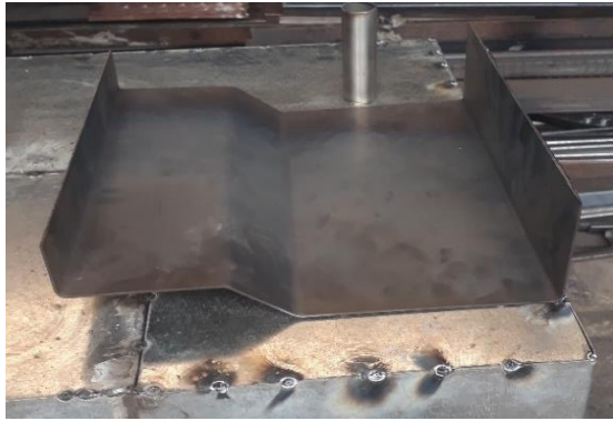
Figura 13-2: Diseño y construcción del embudo giratorio
