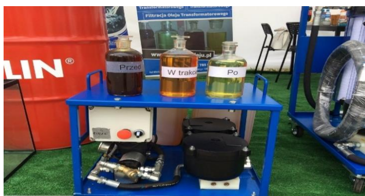
Figura 2-1: Fin del proceso de tratamiento de aceites usados
