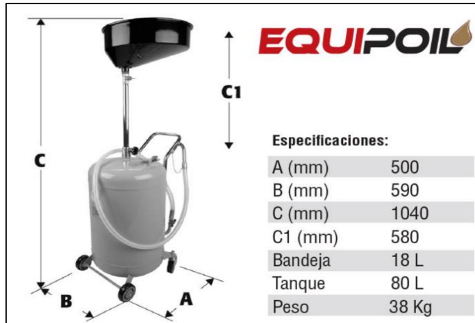
Figura 10-1: Características y especificaciones de un contenedor por gravedad
