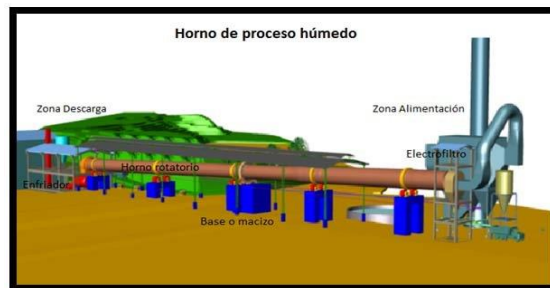
Figura 3-1: Estructura de hornos de cementeras.
