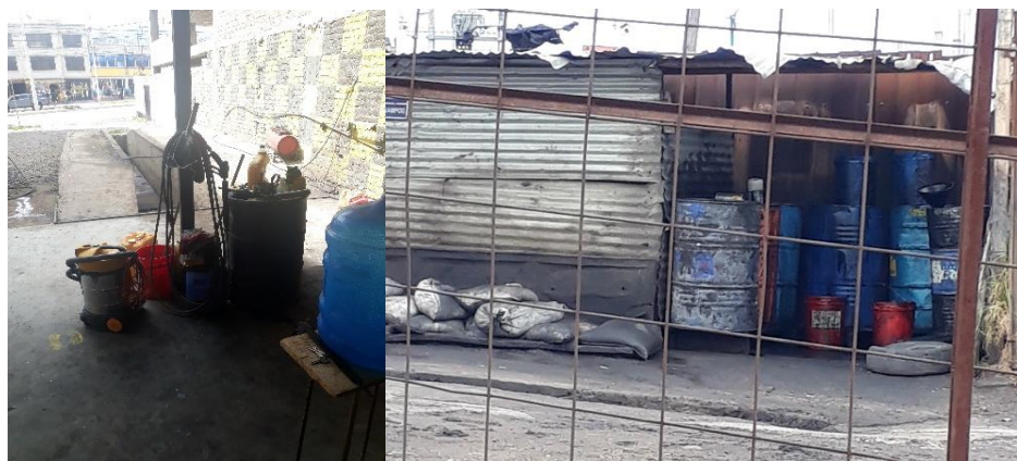
Figura 2-3: Contenedores sin rotulados de residuos tóxicos para aceites residuales.
