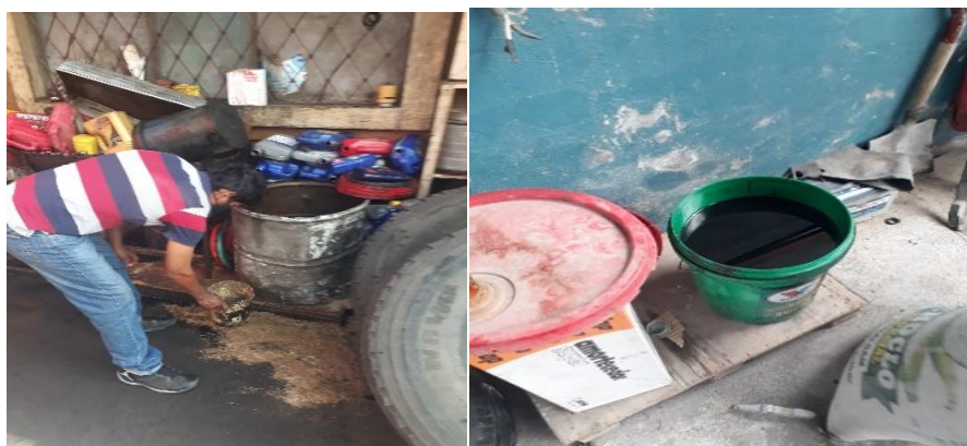
Figura 3-3: Contenedores de aceite sin tapa y sin ningún lugar de protección
