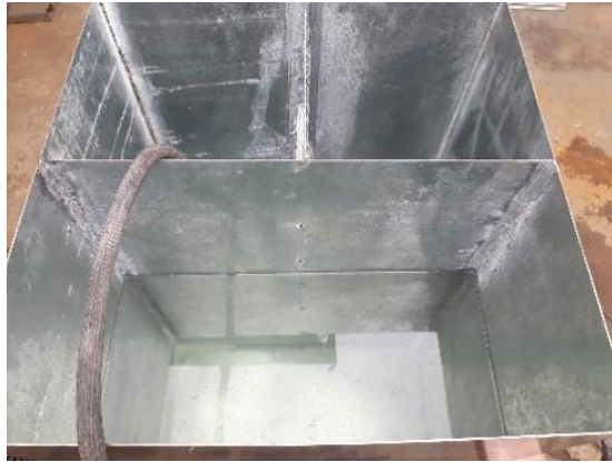
Figura 11-2: Verificación de fugas del contenedor
