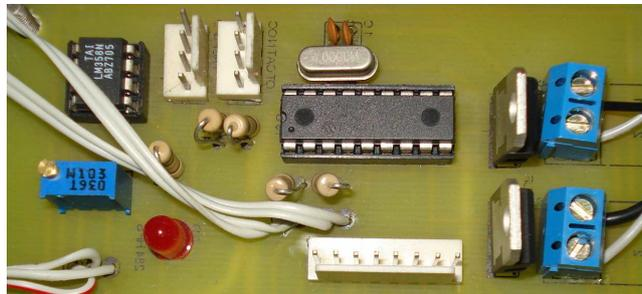
*Figura III.21. Circuito de Potencia de los sensores de contacto y el SHARP GP2Y0A02.*
