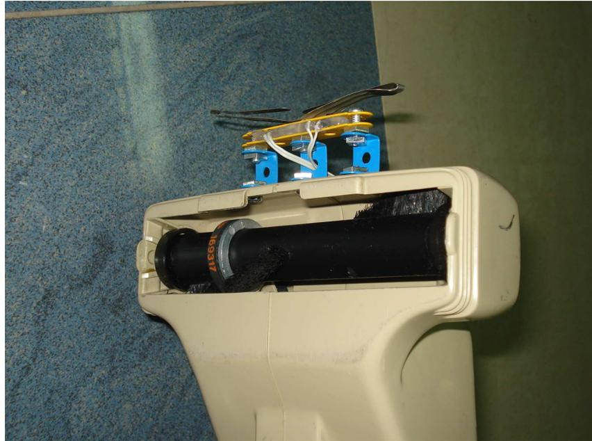
*Figura III.3. Motor para aspirar la basura.*
