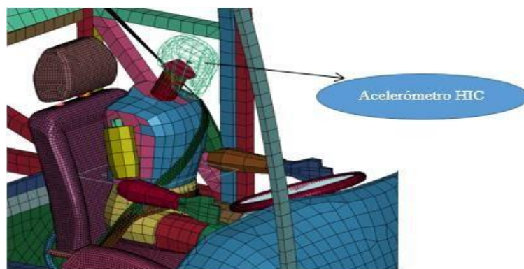
Figura 13-4: Acelerómetro en cabeza utilizado para calcular el criterio de lesión en la cabeza HIC .
