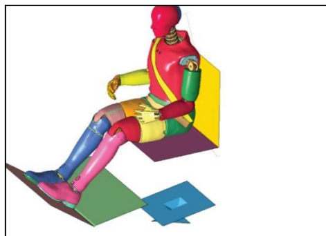
Figura 8-2: Modelo de dummy de pruebas para colisiones HIBRIDO III generado por LSTC-LSDYNA.
