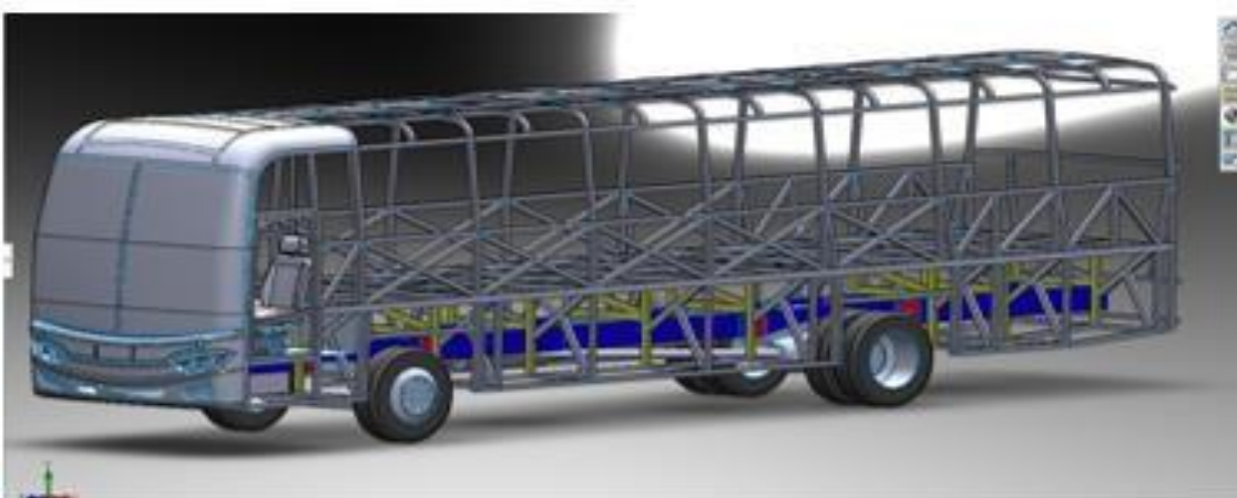
Figura 3-3: Modelado de la carrocería MERCEDES-BENZ OF-1723/59 en Solidworks. a) Vista en perspectiva de la carrocería, b) Vista lateral disposición del motor, c) Unión de anclajes al chasis.
