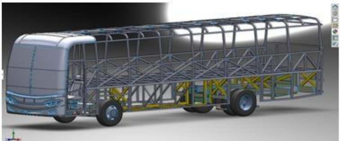
Figura 4-3: Modelado de la carrocería MERCEDES-BENZ O 500 RS 1836 / 30 en Solidworks. a) Vista en perspectiva de la carrocería, b) Vista lateral disposición del motor, c) Unión de anclajes al chasis.
