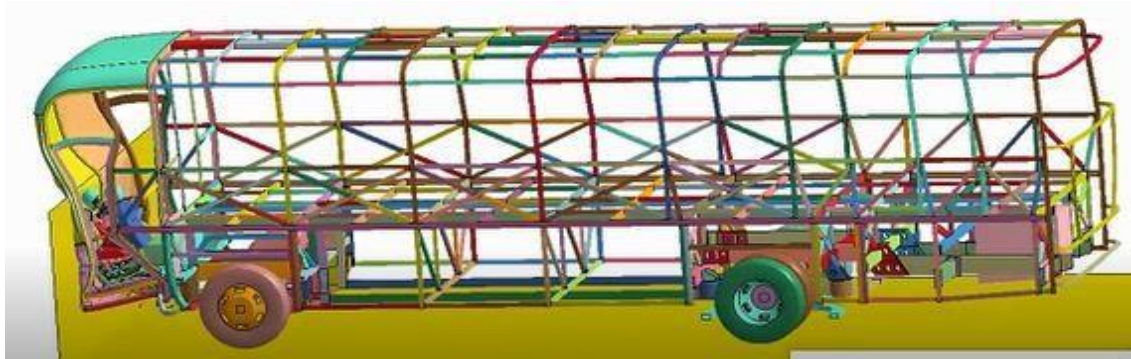
Figura 12-2: Impacto frontal de autobús método FEM. software LS-DYNA.
