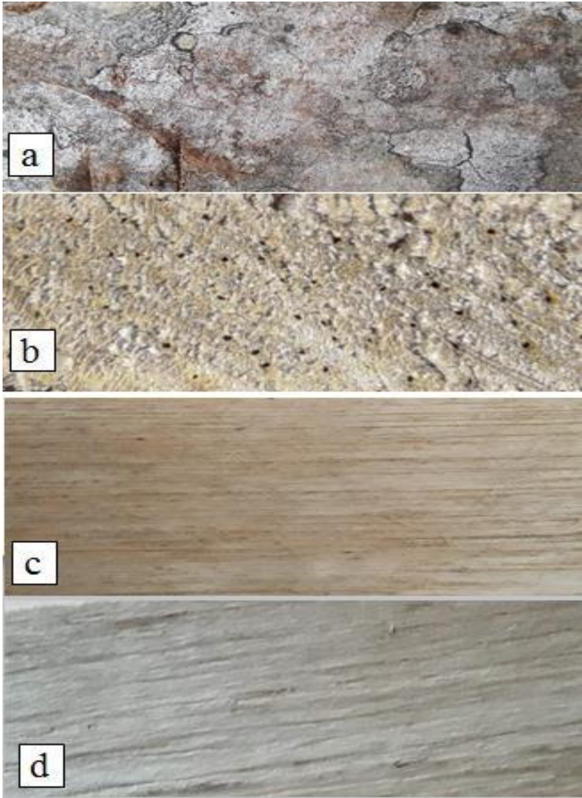
Figura16-3. Jacaranda copaia a. corteza. b. corte transversal. c. corte tangencia. d. corte radial.
