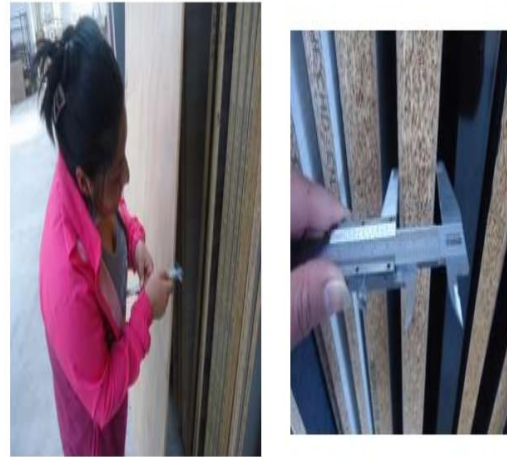
Toma de datos de espesores
