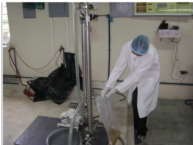
FOTOGRAFÍA No 7. OBTENCIÓN DEL JUGO CLARIFICADO DE ARAZÁ POR MFT
