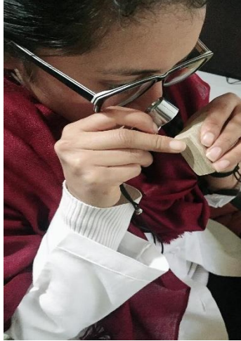
Figura 18-2: Observación de las muestras de madera con lupa de 10X Realizado por: Caiza Elizabeth, 2020
