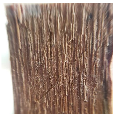
Figura 233-3: Corte radial de Terminalia amazonia .
