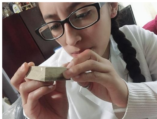
Figura 12-2: Identificación del lustre de la madera Realizado por: Caiza Elizabeth, 2020
