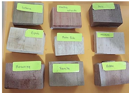
Figura 2-2: Muestras de madera de 6x4x2 cm, etiquetadas Realizado por: Caiza Elizabeth, 2020
