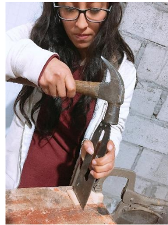
Figura 17-2: Corte de las muestras de madera Realizado por: Caiza Elizabeth, 2020
