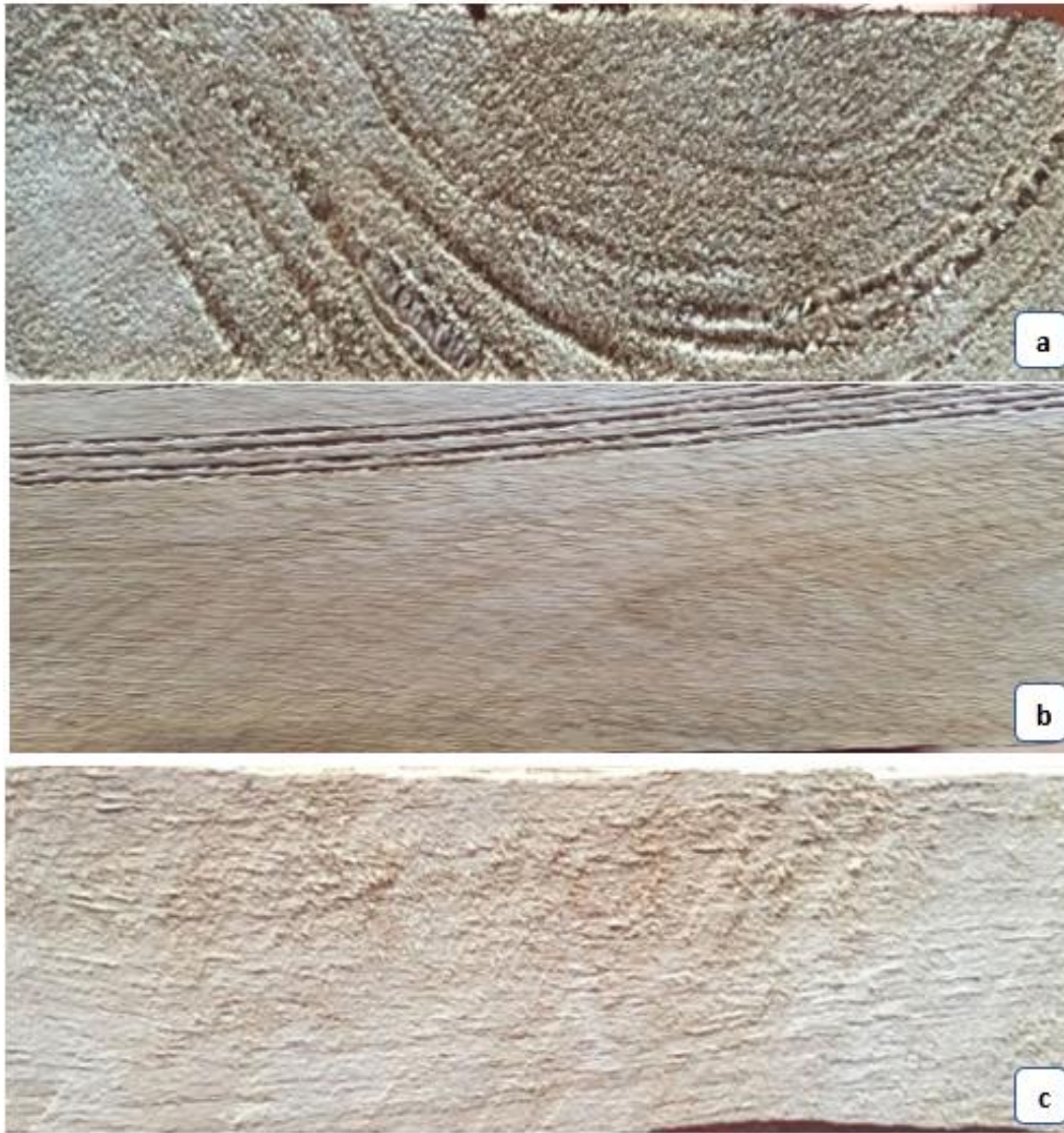
Figura 7-3: Apeiba membranacea Spruce ex Benth Peine de mono. a. Corte transversal. b. Corte tangencial. c. Corte radial.
