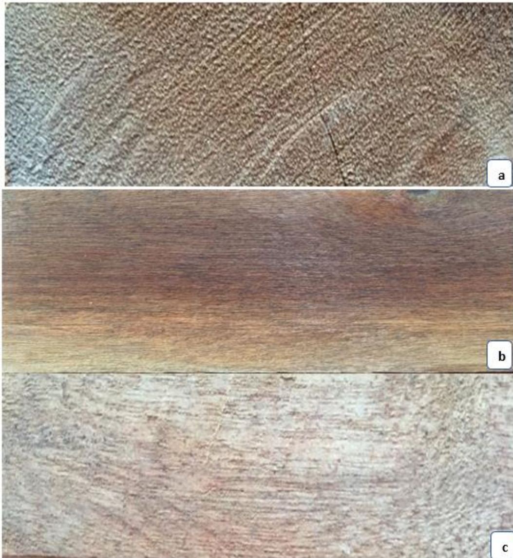
Figura 8-3: Viola glycyarpa Ducke Sangre de gallina. a. Corte transversal. b. Corte tangencial. c. Corte radial.
