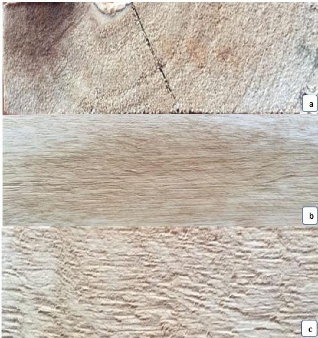
Figura 9-3: Jacaranda copaia Jacaranda. a. Corte transversal. b. Corte tangencial. c. Corte radial.
