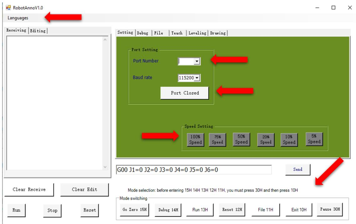
**Figura 10-3.** Interfaz de configuraciones para el arranque del robot
