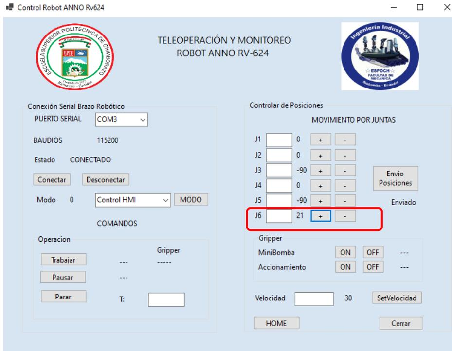
**Figura 3-4.** Movimiento de las juntas de forma individual.
