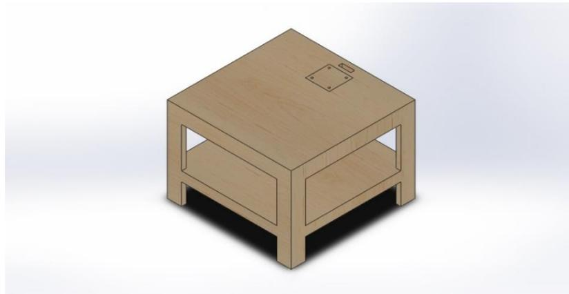
**Figura 15-3.** Diseño 3D de la bancada para el brazo robótico.
