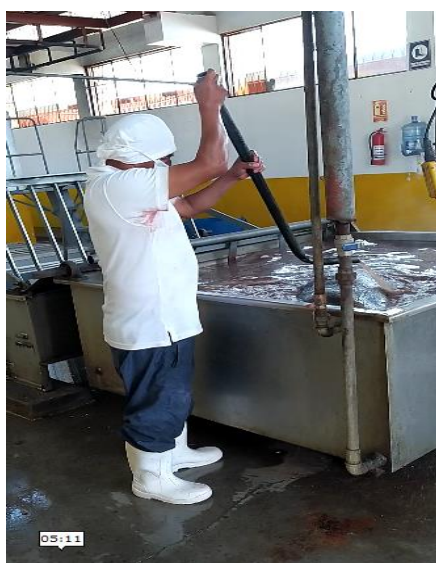
Figura 5- 3: Tanque de ablandamiento
