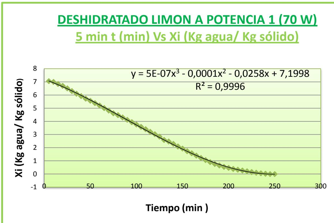
GRAFICO N°1 CURVA DE DESHIDRATACIÓN DEL LIMON EN MICROONDAS A POTENCIA 1 (70 W) a 5 min
