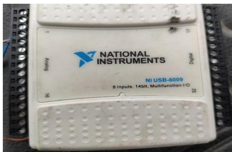
Figura 12-2. Tarjeta National Instruments NI USB 6009 Fuente: Autor
