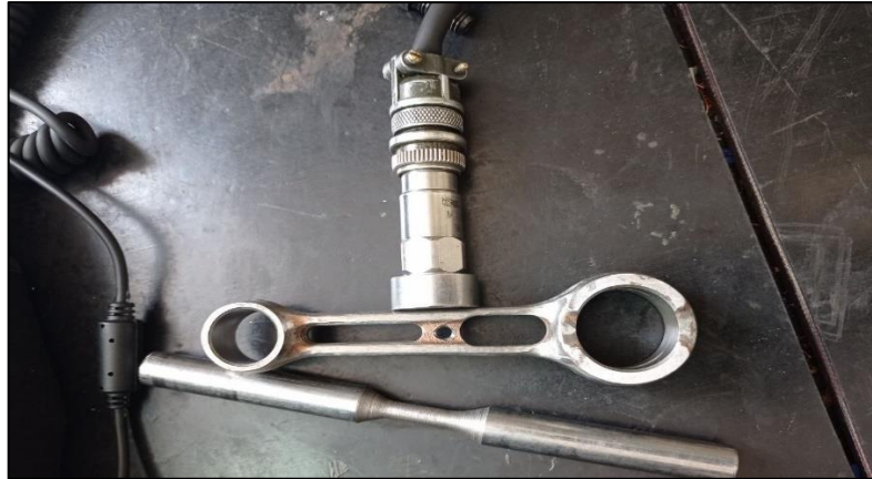
Figura 40-4. Sensor predisposto sobre el diseño de biela propuesta Fuente: Autor
