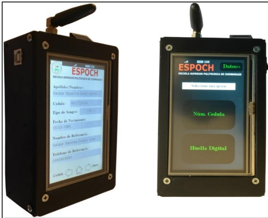
Figura 23-3. Equipo Terminal ensamblado en la caja 3D.
