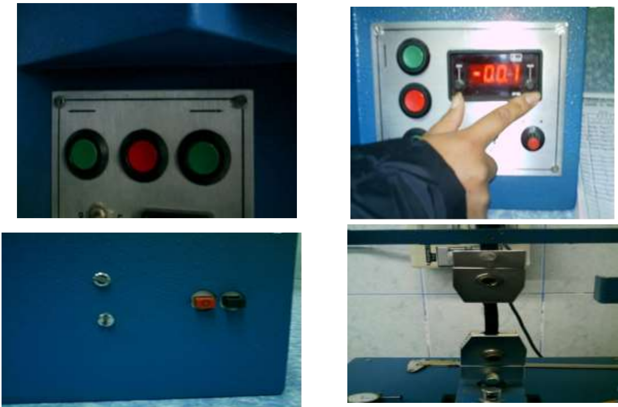
Figura 3-2. Encendido del equipo para medir la resistencia a la tensión
