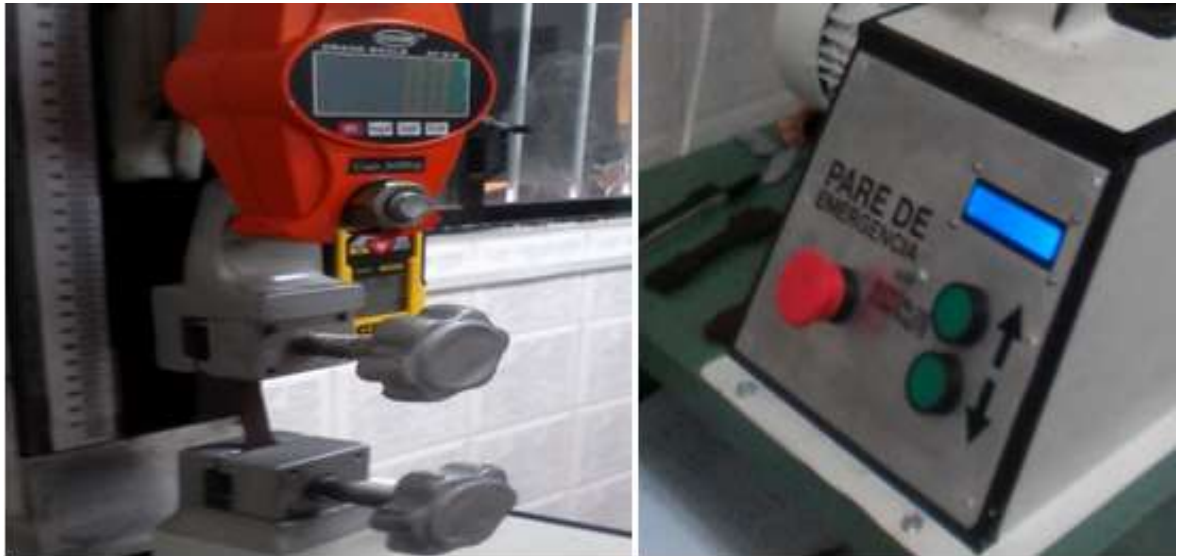
Figura 2-2. Máquina para el test de resistencia a la tensión.
