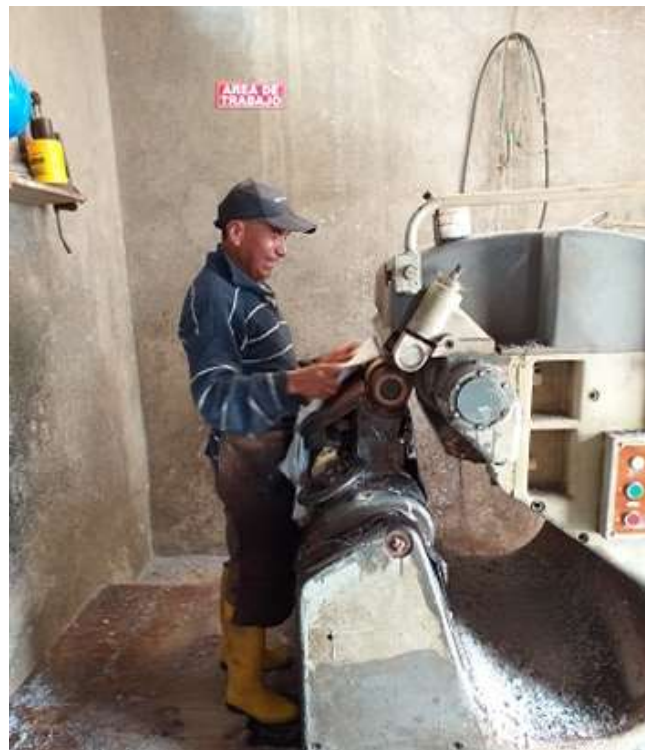
Anexo P. Evidencia fotográfica del proceso de rebaje de los cueros a un calibre de 1,2 mm.
